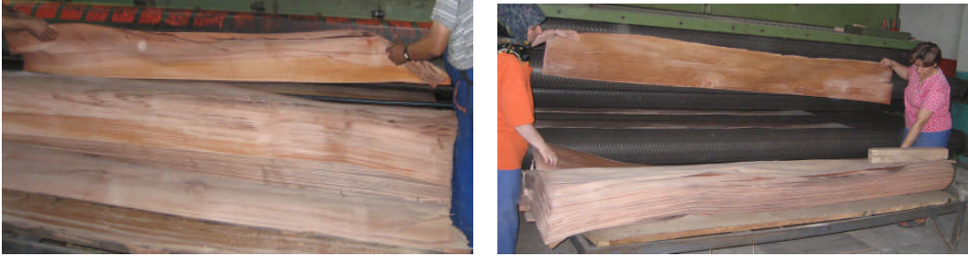
Resim 1.13: Kesilen kaplamaların sırayla makineden alınması ve kurutma fırınına verilmesi
