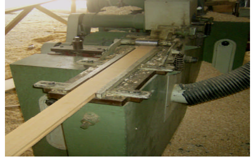
Resim 1.5: Profil ve rabita makinesinde lambri yapılması
