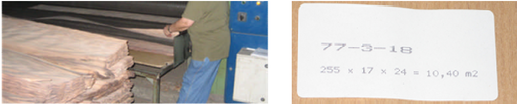
Resim 1.14: Kaplamaların kurutma bandından alınması ve etiketlenmesi
