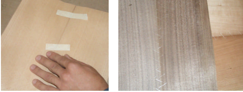
Resim 1.10: Kaplamaların bantlanması ve dikilmesi
