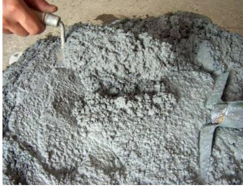
Resim 2.5: 400 dozlu çimento harcı
