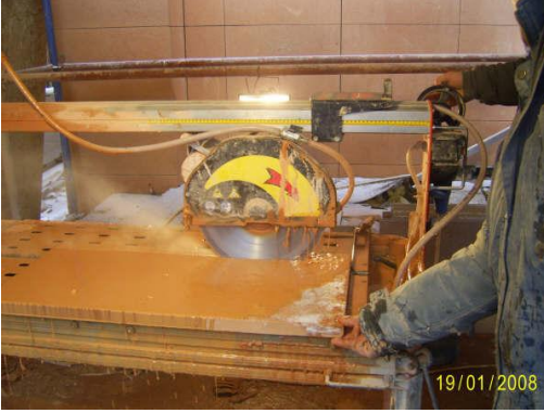
Resim 1.12: Taş kesme makinesi
