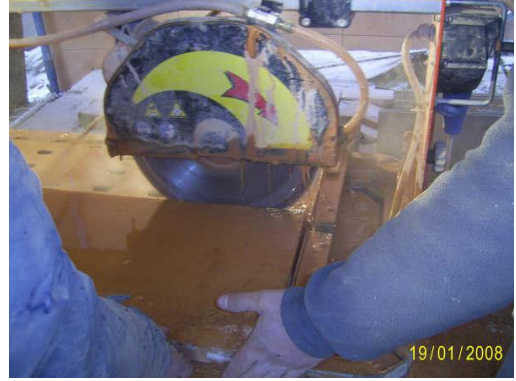
Resim 1.13: Taş kesme makinesi
