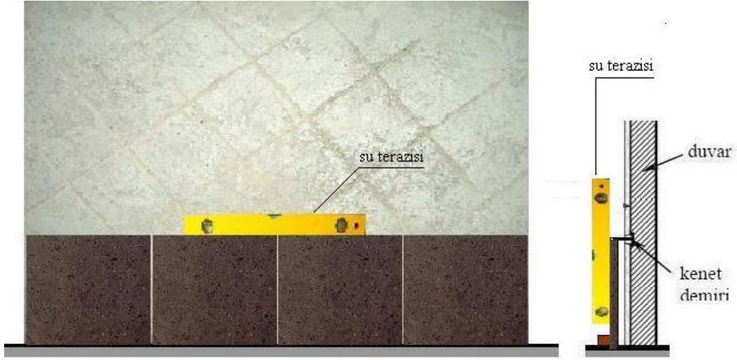
Resim 2.8: Yere paralellik ve diklik kontrolü
