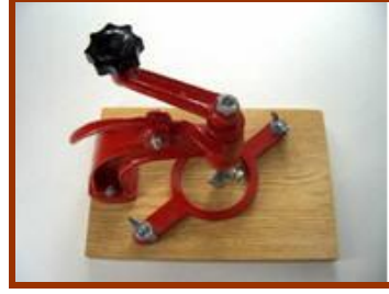
Resim 2.14: Lastik mala ve mekanik seramik delme aleti
