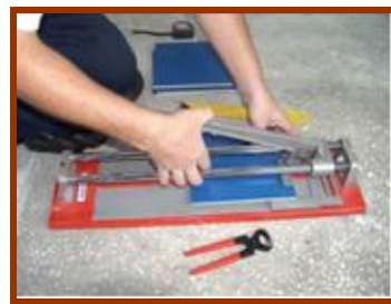
Resim 2.11: Şapkalı gönnye ve seramik kesme aleti
