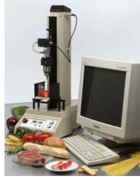
Resim 2.5: Gıdalarda dokusal özelliklerin ölçümünde kullanılan farklı enstrüman çeşitleri
