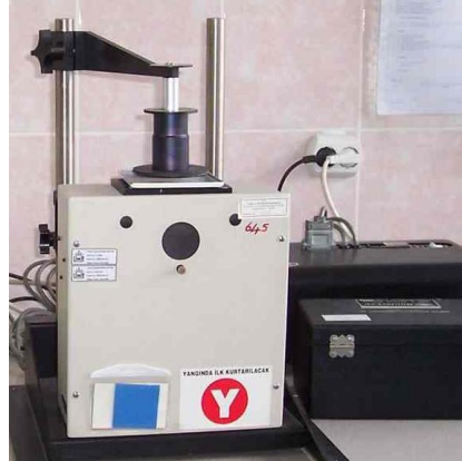
Resim 1.10: Hunter kolorimetresi (renk tayin cihazı)
