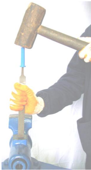
Resim 1.34: Çift paralı plastik eđe sapının iç parasını takma işlemi
