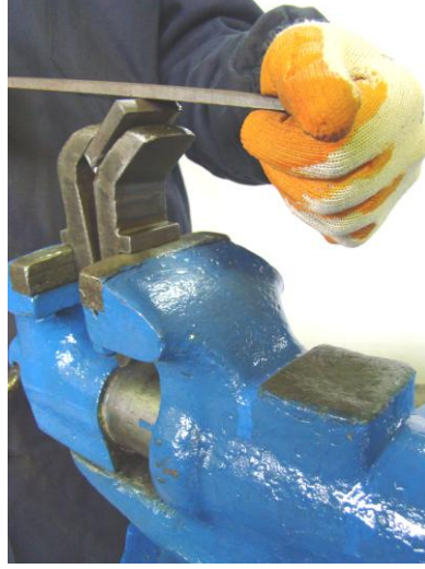
Resim 1.51: Pah mengenesi ile eğeleme
