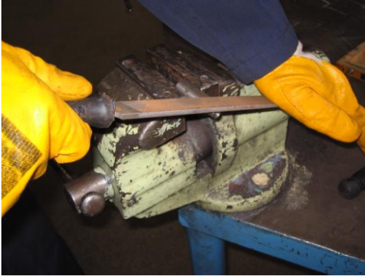
Resim 2.4: Menteşe dış yüzeyinin eğelenmesi
