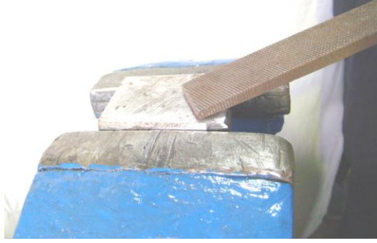
Resim 1.50: Ege uç kısmını kullanma
