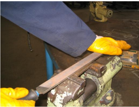
Resim 1.48: Düz geniş yüzeylerde eğeleme
