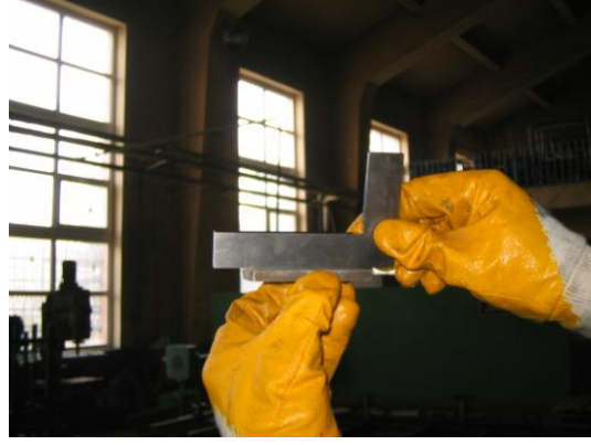
Resim 1.52: Kıl gönye ile yüzey kontrolü
