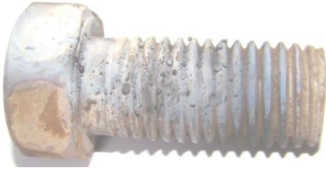
Resim 1.29: Dişleri ark çapakları almış cıvata
