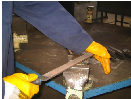
Resim 1.49: Düz dar yüzeylerde eğeleme
