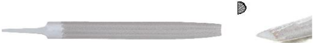
Resim 1.7: Balık sırtı eğenin farklı görünüşleri
