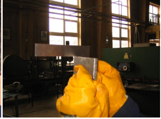
Resim 1.54: Geniş yüzey ile dar yüzeyin açı kontrolü
