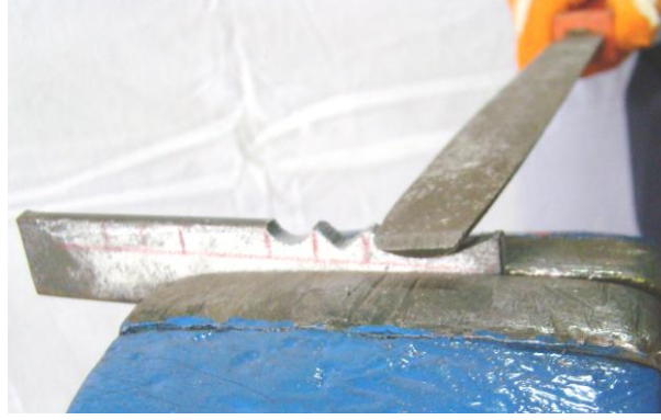
Resim 2.3: Yarım oval, elips ve kavisleri oluşturmak
