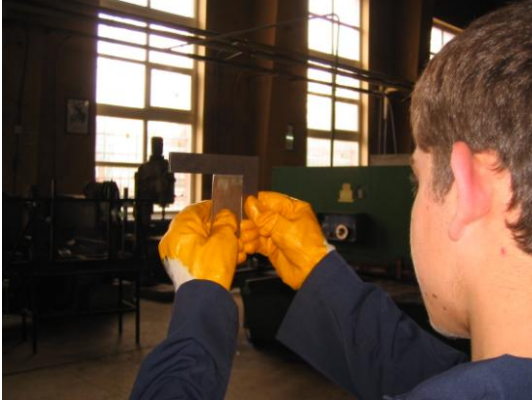
Resim 1.53: Dar yüzeylerin açı kontrolü
