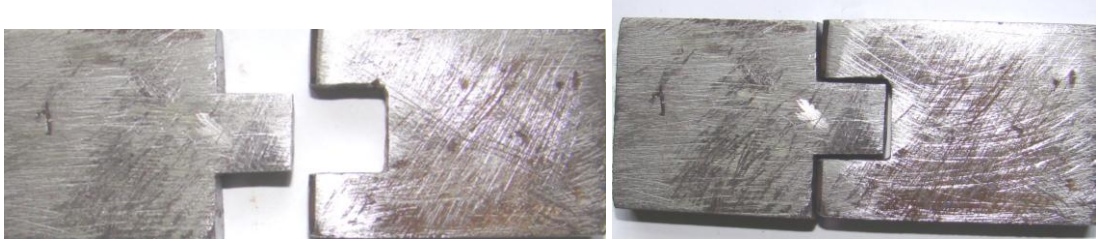
Resim 2.6: Eđelemede yzey iřleme kalitesi uygulanmıř iř paraları
