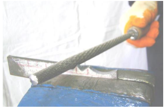
Resim 2.2: Kavisli (yarım yuvarlak) yüzeyleri oluşturma
