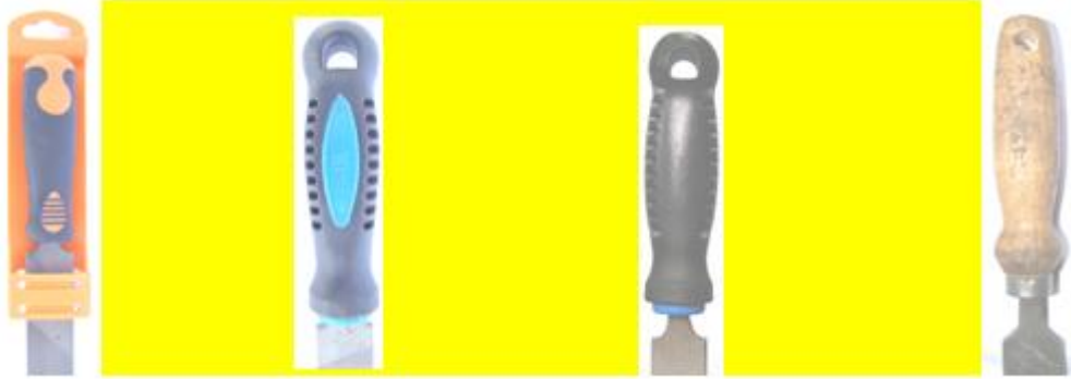
Resim 2.7: Farklı eęe saplarının takılma biçimleri
