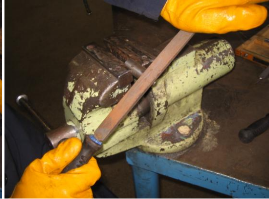
Resim 2.5 Menteşe dış yüzeyinin eğelenmesi
