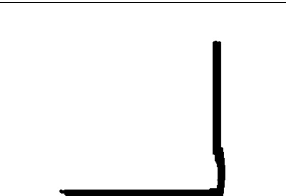
Şekil 2.3: Hareketli eğme çenesi sac kalınlığından fazla iken bükülmüş hatalı parça
