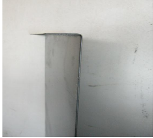
Resim 2.11: Tekniğe uygun bükülmüş gereç
