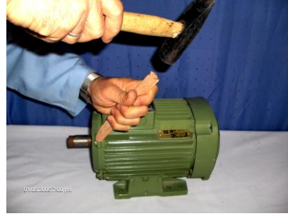
Resim 1.8: a) Motor kapak civatalarının sökülmesi b) Kapaklarının sökülmesi
