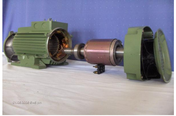
Resim 1.5: Asenkron motorun kesit görünüşü ve sökülmiş hâli
