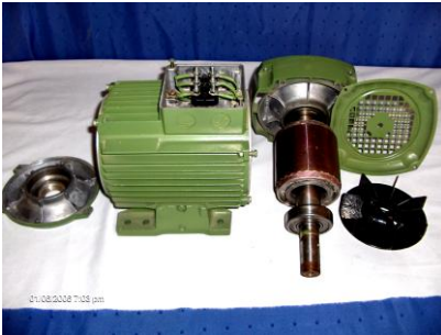
Resim 1.9: a) Motorun parçaları çıkarılmış hâli b) rulmanın çekirme ile çıkarılması
