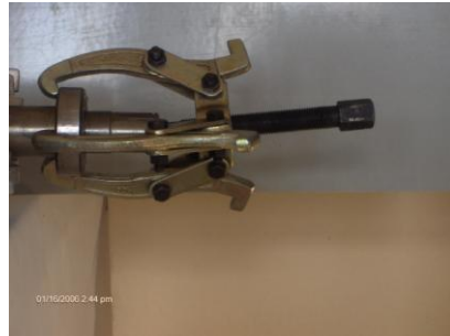
Resim 1.9: a) Motorun parçaları çıkarılmış hâli b) rulmanın çekirme ile çıkarılması
