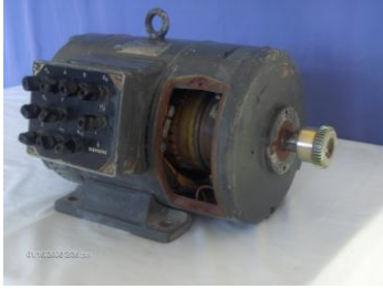
Resim 1.19: a) Motor kapaklarının işaretlenmesi b) Dişlinin sökülmesi
