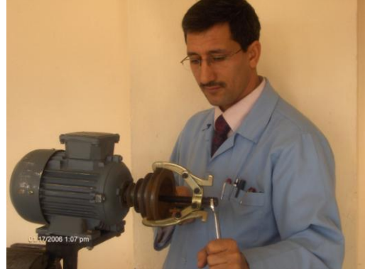
Resim 1.7: a) Dişlinin çekirme ile sökülmesi b) Kasnağın çekirme ile sökülmesi
