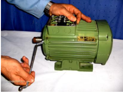
Resim 1.8: a) Motor kapak civatalarının sökülmesi b) Kapaklarının sökülmesi
