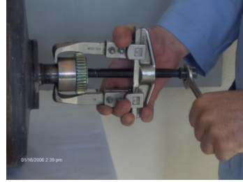
Resim 1.19: a) Motor kapaklarının işaretlenmesi b) Dişlinin sökülmesi
