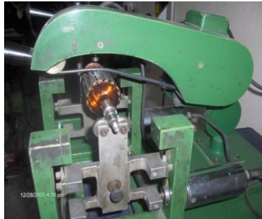
Resim 3.4: Endüvinin balans makinesine yerleştirilmesi
