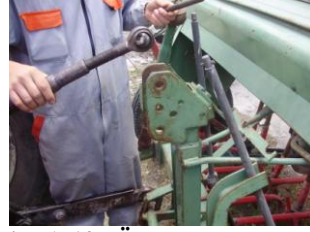
Resim 1.64: Üst bağlantı kolunun sökülmesi
