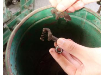
Resim 3.25: Sıyırıcı, itici ve yay yataklarının çıkarılması
