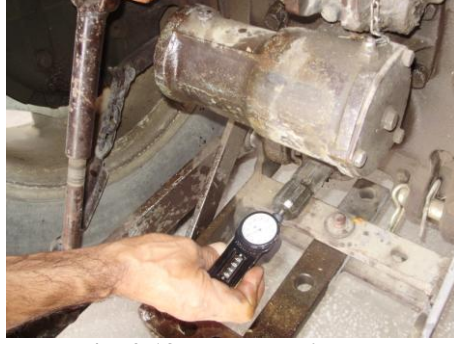
Resim 2.13: Turmetre ile ölçüm
