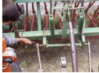
Resim 1.44: Ayarlı yan bağlantı kolunun bağlanması
