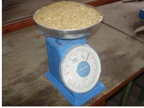
Resim 1.16: Beze dökülen tohum miktarının tartılması
