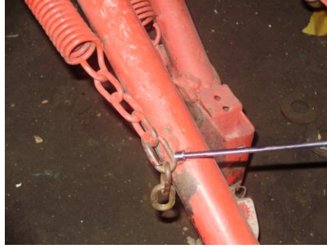
Resim 2.11: Ekici ayakların çeki yayları ile desteklenmesi
