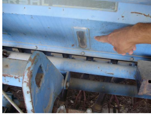
Resim 1.31: Tohum deposu seviye penceresi
