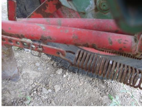
Resim 1.28: Ekici ayakların çeki yayları ile desteklenmesi
