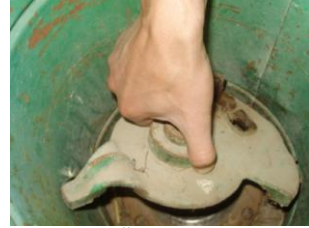
Resim 3.26: Üst baskı plakasının çıkarılması
