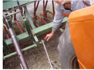
Resim 1.66: Ayarsız yan bağlantı kolunun sökülmesi
