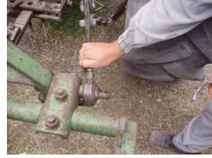
Resim 4.39: Ayarlı yan bağlantı kolunun sökülmesi
