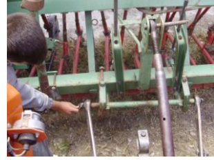
Resim 1.65: Ayarlı yan bağlantı kolunun sökülmesi
