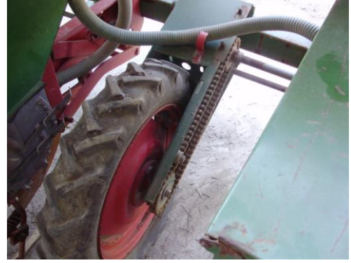
Resim 4.11: Gübre dişli ayar düzeni
