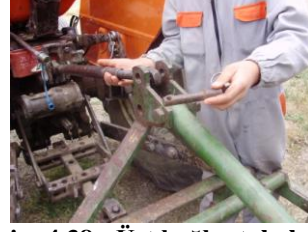
Resim 4.38: Üst bağlantı kolunun sökülmesi
