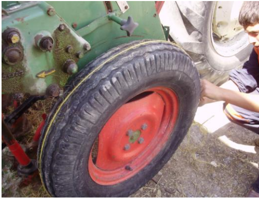
Resim 1.12: Teker çevresinin ip ile ölçümü
