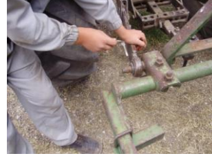
Resim 4.40: Ayarsız yan bağlantı kolunun sökülmesi
