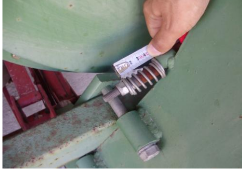
Resim 4.2: Aspiratör gergi milinden kayış ayarı
