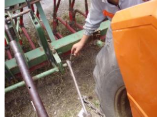
Resim 1.43: Ayarsız yan bağlantı kolunun bağlanması
