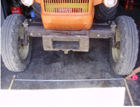
Resim 1.22: Traktör ön tekerlekleri arası mesafe (ortadan ortaya)
