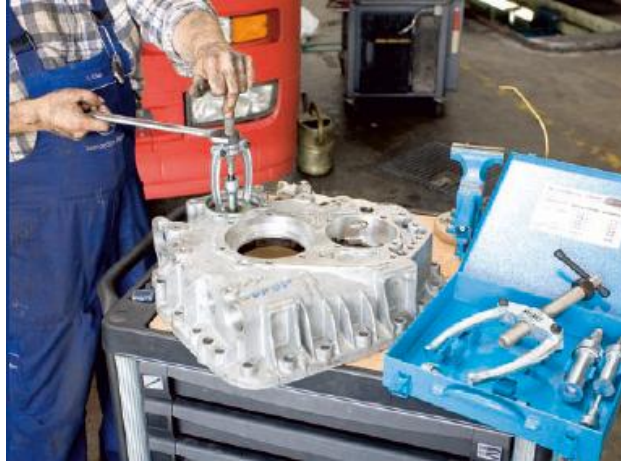
Resim 1.62: İç çap rulman çekirme uygulaması
