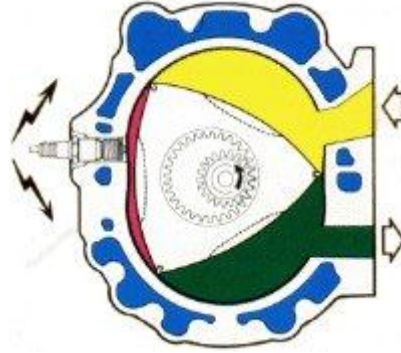
Şekil 2.14: Wankel motor çalışması
