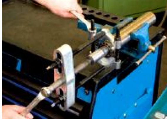
Resim 1.60: Dış çap rulman çekilmesi uygulaması
