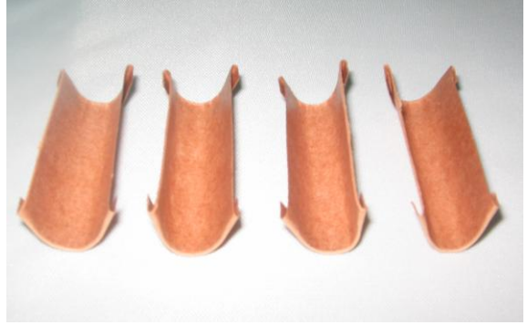
Resim 2.6: Presbantların ucunu katlama
