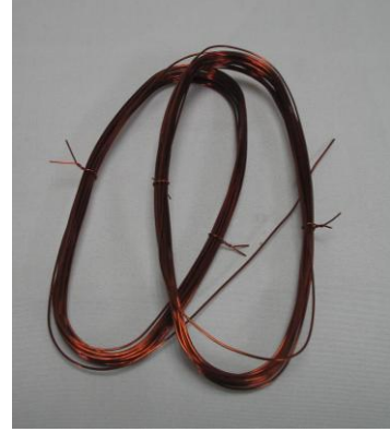
Resim 2.3: Sarılmış bobin grubu
