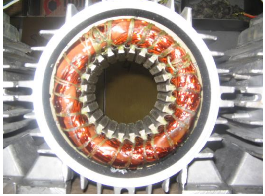
Resim 2.19: Bobinlerin iple bandajlanması
