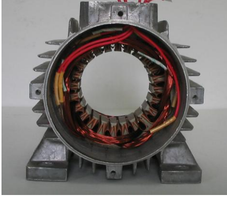
Resim 2.16: Bobin giriş-çıkış uçlarının çıkarılması Resim 2.17: Bobinlerin birbiri ile yalıtılması
