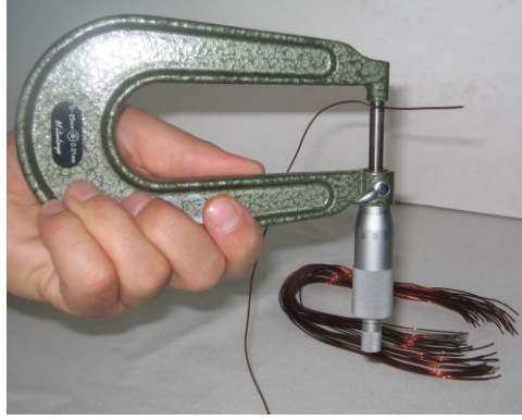
Resim 1.7: Mikrometre ile tel çapını ölçme
