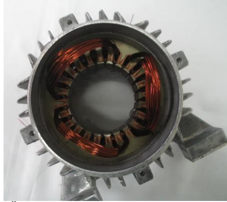
Resim 2.11: Üçüncü bobin grubunun yerleştirilişi (birinci kat)
