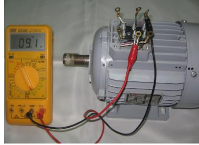
Resim 1.3: Faz sargılarının kontrolü
