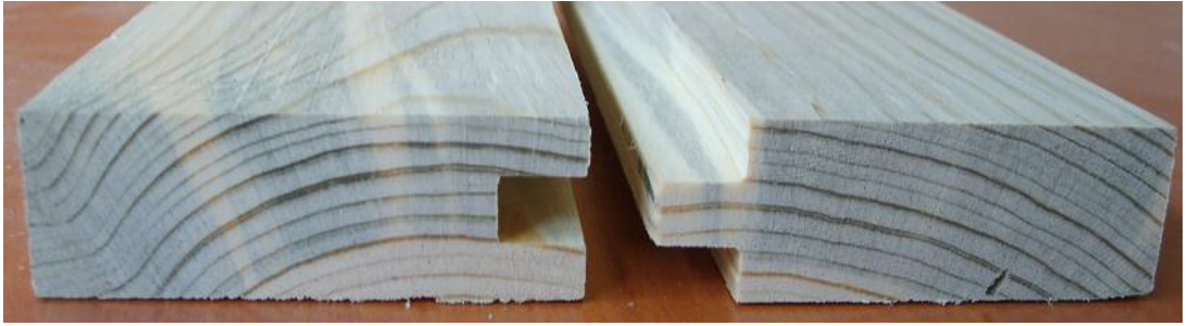
Resim 1.6: Kınışlı en birleştirme (erkekli- dişili)
