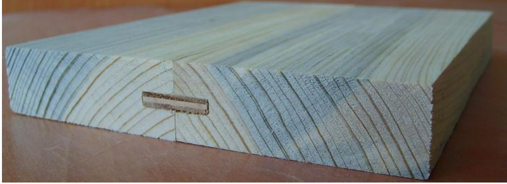
Resim 1.5: Yabancı çıtalı kırışli en birleştirme
