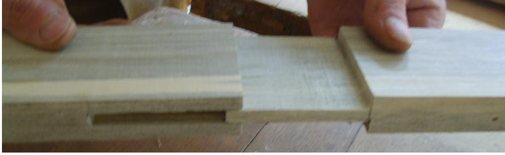
Resim 2.3: Zıvanalı boy birleştirme
