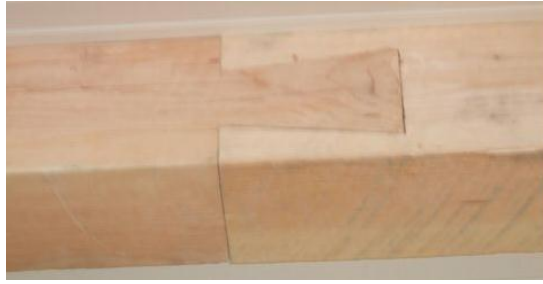
Resim 2.8: Kırlangıçkuyruğu boy birleştirme
