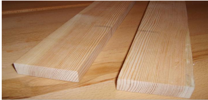
Resim 1.2: Düz en birleştirme
