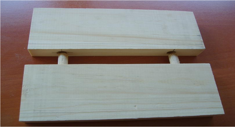
Resim 1.7: Kavelalı en birleştirme
