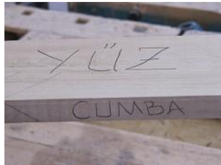
Resim 1.47: Ahşap malzemenin yüz, cumba ve maktası
