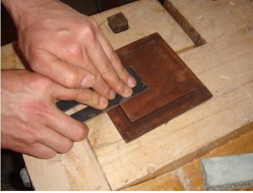
Resim 1.15: Yağ taşları ve yağ taşında bileme
