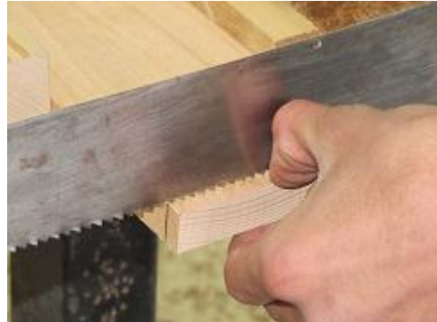
Resim 2.13: Parçanın gönye ile markalanması ve kesilmesi
