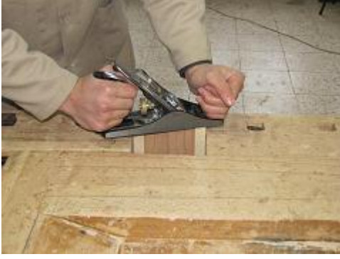
Resim 1.53: İş parçasının maktasının rendelenmesi ve gönye kontrolü
