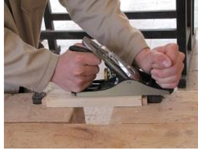
Resim 1.50: Kenedin iş parçasının baş ve sonundaki konumu
