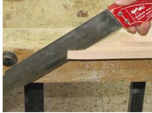
Resim 2.16: Parçanın boyuna kesilmesi
