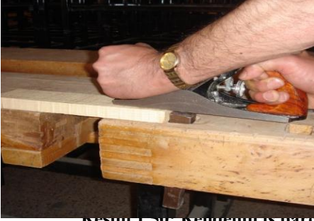
Resim 1.50: Kenedin iş parçasının baş ve sonundaki konumu
