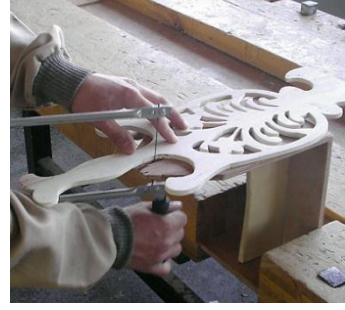
Resim 2.7: Kıl testere ve uygulaması
