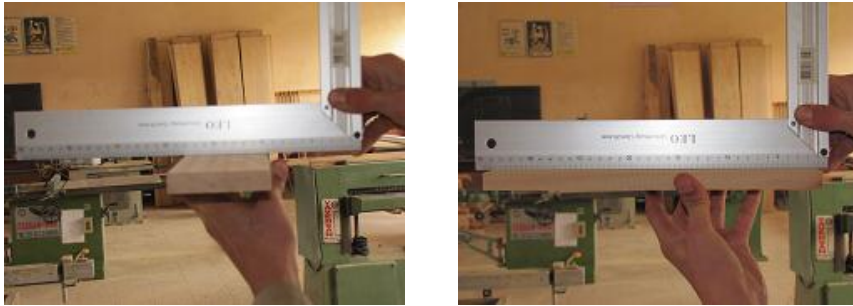
Resim 1.49: Parça yüzeyinin gönyesinin kontrol edilmesi
