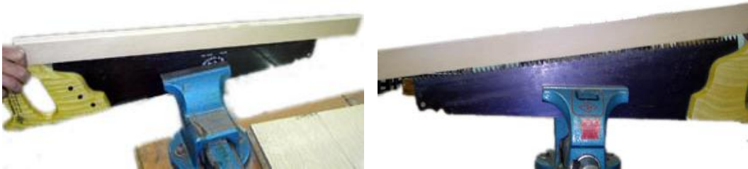
Resim 2.12: Diş ucu doğrusu kontrolleri
