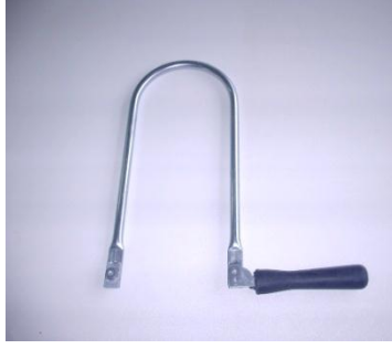
Resim 2.7: Kıl testere ve uygulaması
