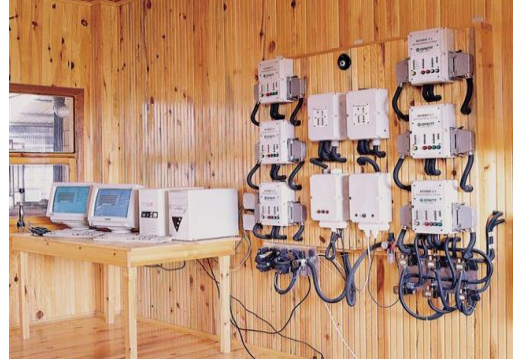
Resim 1.2: Kurutma fırını ve kontrol ünitesi
