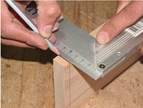
Resim 2.13: Parçanın gönye ile markalanması ve kesilmesi
