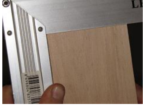
Resim 1.53: İş parçasının maktasının rendelenmesi ve gönye kontrolü
