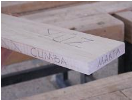
Resim 1.47: Ahşap malzemenin yüz, cumba ve maktası
