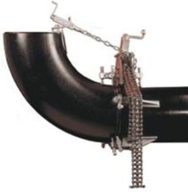
Resim 5.2: Boruların kaynağında sabitlemeyi sağlayan aparatlardan biri
