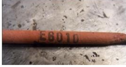
Resim 1.4: Üzerinde numarasıyla elektrot
