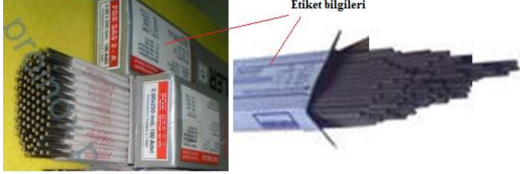
Resim 1.3: Farklı markalara ait elektrotların etiket bilgileri
