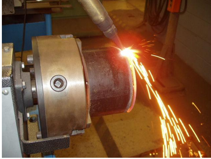
Resim 4.3: Boruya kaynak ağızı açma
