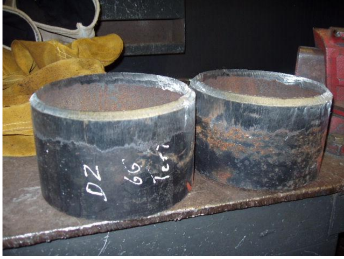
Resim 4.2: Kaynak ağızı açılmış borular
