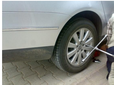
Resim 1.7: Bijon anahtarı ve kullanımı
