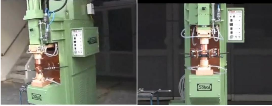
Resim 1.8: Bijon anahtar kaynağı yapan nokta kaynak makinesi
