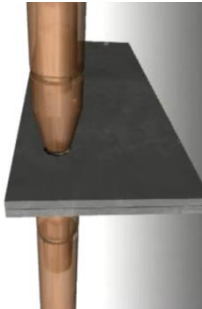
Çizim 1.9: Sac parçaların nokta kaynağıyla birleştirilmesi
