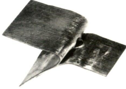
Resim 1.4: Nokta kaynağıyla elde edilen sökülemez birleştirme
