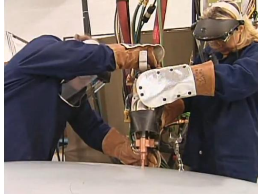
Resim 1.6: Taşınabilir nokta kaynak makinesi ve kullanımı
