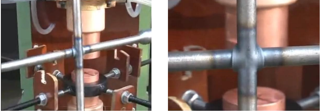
Resim 1.12: Kaynaklı birleştirme sonucu
