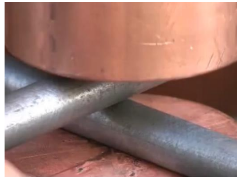
Resim 1.9: Bijon anahtarının elektrotlar arasındaki konumu
