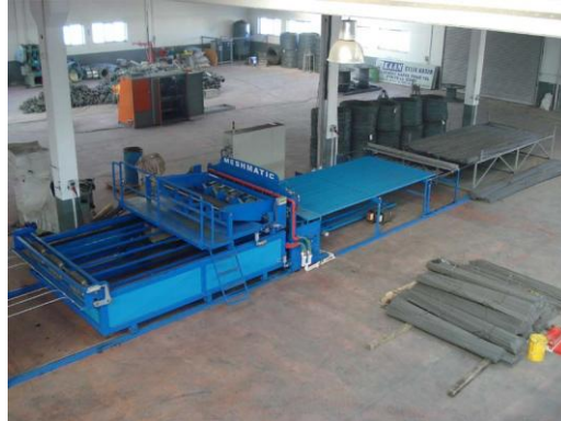
Resim 2.4: Hasır çelik kaynak makinesi ve kaynağın yakından görünüşü
