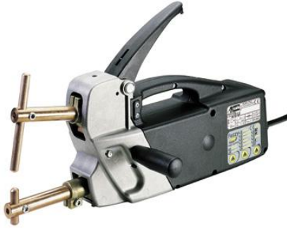
Resim 1.6: Taşınabilir nokta kaynak makinesi ve kullanımı
