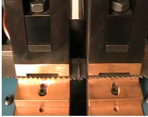
Resim 2.7: Direnç alın kaynak makinesinde testere lamasının kaynatılması
