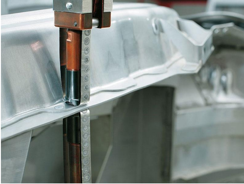
Resim 2.8: Özel elektrotla otomobil kaportasının kaynatılması
