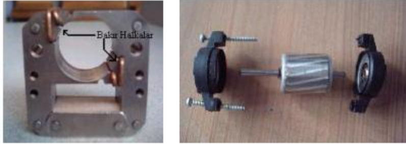
Resim 1.6: Gölge kutuplu motora ait stator, rotor ve kapakları
