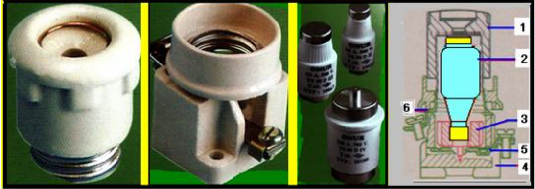
Resim 1.14: Buşonlu sigorta ve parçaları (1. sigorta kapağı 2. buşon 3. viskontakt 4. gövde 5. dip kontak 6. üst kontak)
