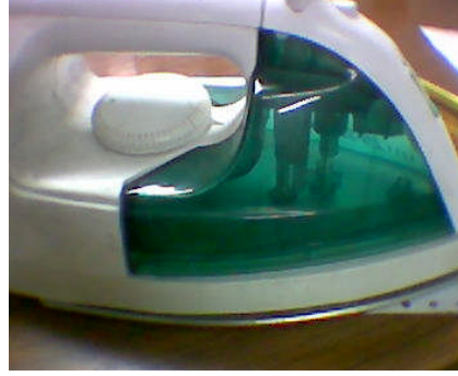
Resim 2.1: Ütünün buhar elemanları
