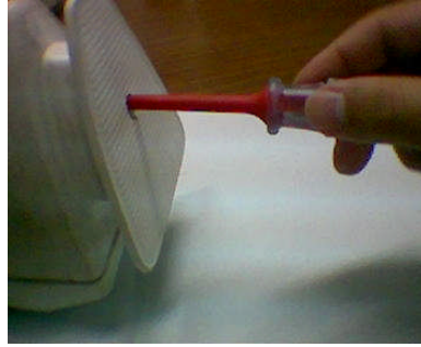
Resim 1.9: Ütünün arka kapağının sökülmesi
