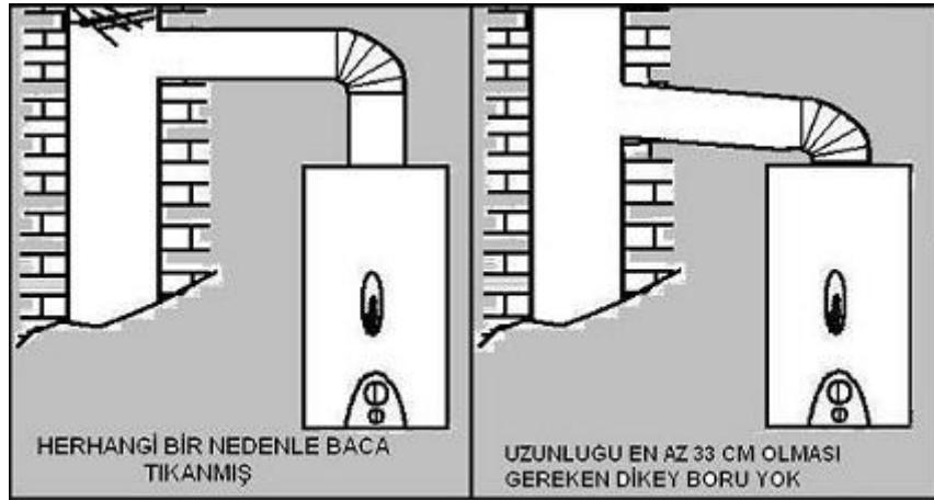
Resim 2.7: Şofben montajında yapılan hatalar
