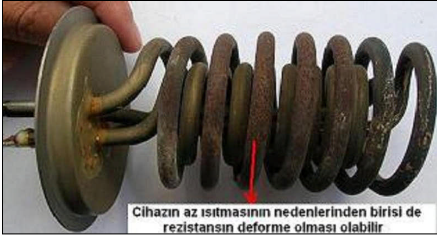
Resim 3.11: Rezistansın deforme olması
