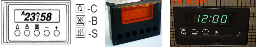
Resim 4.3: Elektronik saatin programlanması
