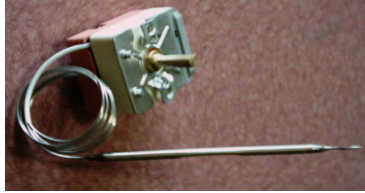
Resim 3.3: Elektrikli ve gazlı fırınlarda kullanılan termostatlar
