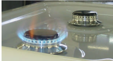
Resim 1.4: Ocaklarda isli yanma
