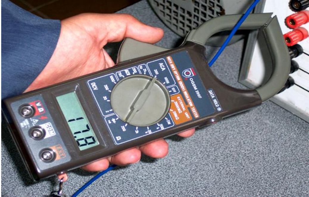
Fotoğraf 4.7: Pens ampermetre ile akım ölçmek
