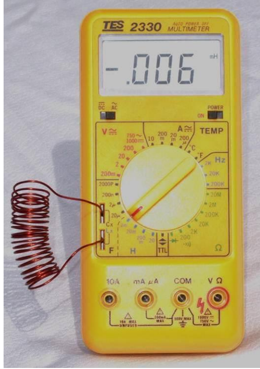
Fotoğraf 2.2: Multimetre ile endüktans ölçme
