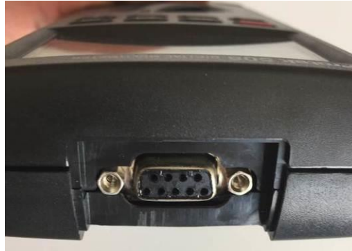
Fotoğraf 1. 11: Dijital ölçüm aleti haberleşme portu
