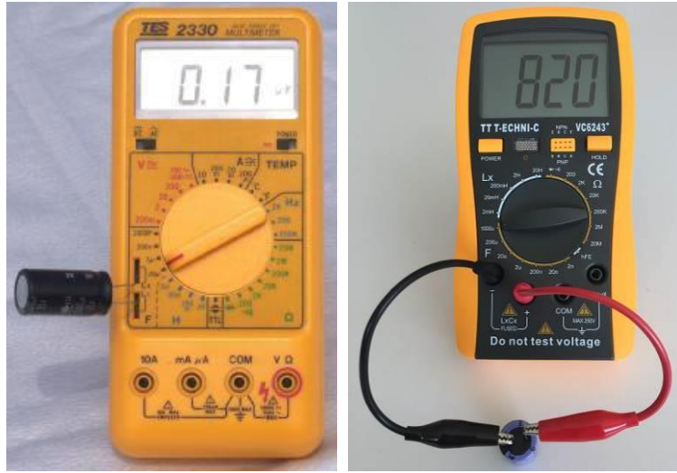
Fotoğraf 6.7: Multimetre ile kapasite ölçme
