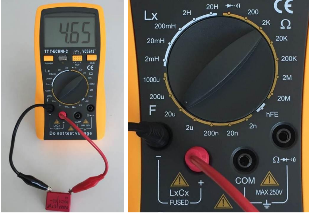
Fotoğraf 3.2: Lcrmetre ile kapasite ölçümü
