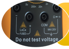
Fotoğraf 2.3: Lcrmetre prob bağlantısında dikkat edilecek hususlar.
