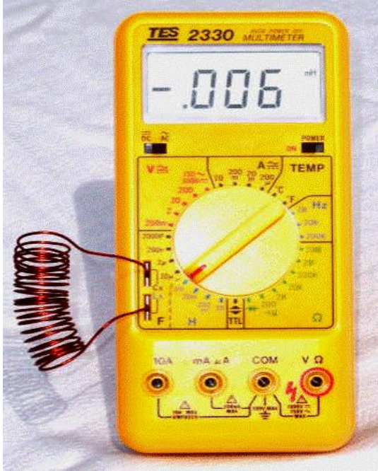
Fotoğraf 6.6: Multimetre ile endüktans ölçme
