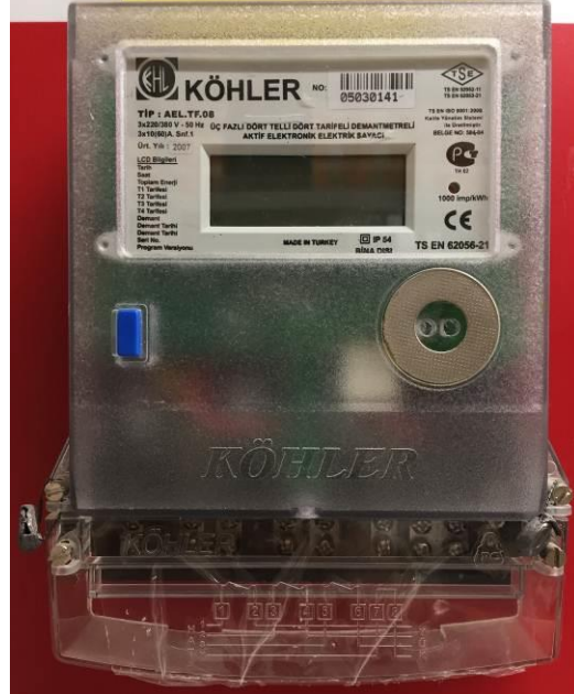
Fotoęraf 1.7: Toplayıcı ölçüm aletlerine en iyi örnek sayaçlardır
