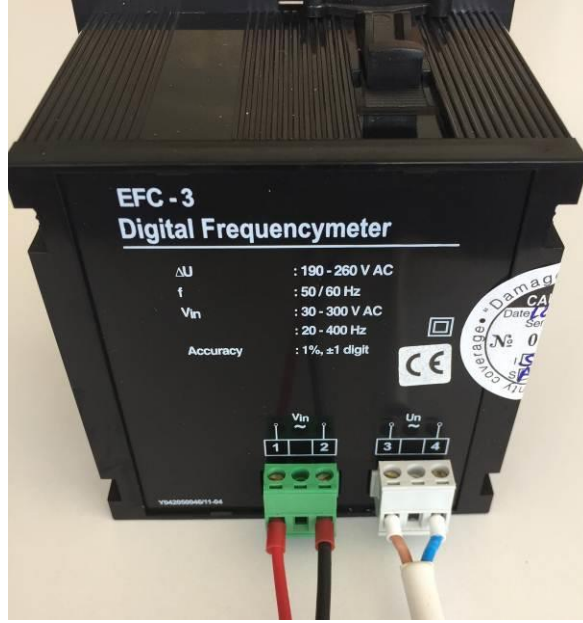
Fotoğraf 7.2: Frekansmetre besleme ve ölçüm klemens bağlantısı
