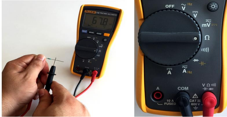
Fotoğraf 1.15: Multimetre ile direnç ölçme
