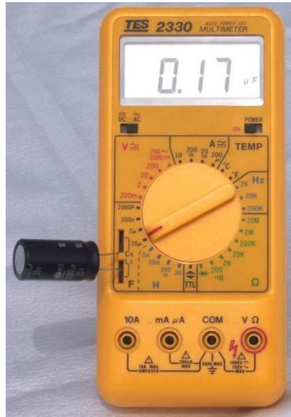
Fotoğraf 3.1: Multimetre ile kapasite ölçümü
