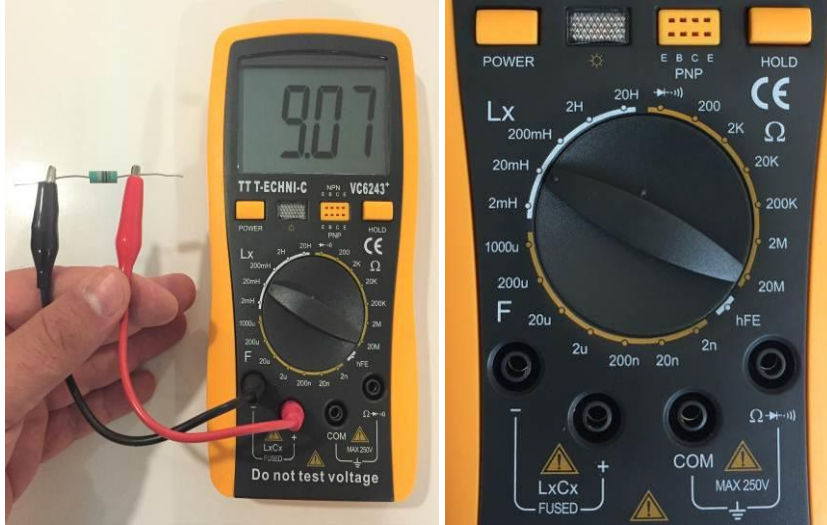
Fotoğraf 2.3: Lcrmetre prob bağlantısında dikkat edilecek hususlar.
