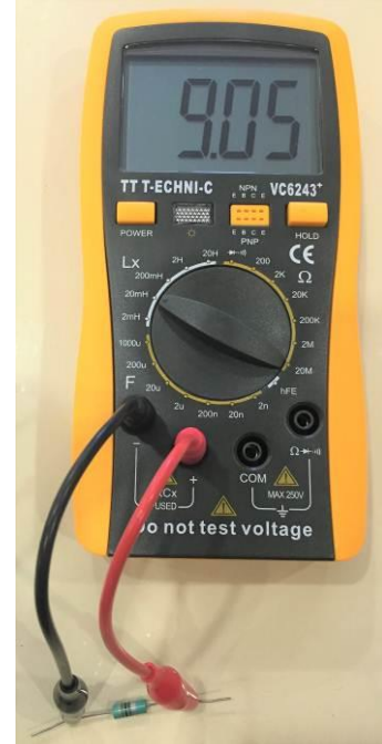
Fotoğraf 6.6: Multimetre ile endüktans ölçme
