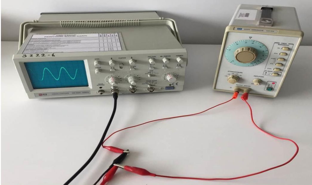
Fotoğraf 9.7: Osiloskop ile frekans ölçme uygulaması
