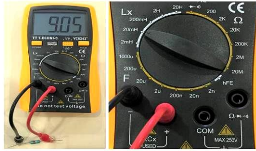
Fotoğraf 2.5: Multimetre ile endüktans ölçme
