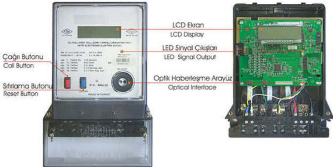
Resim 3.5: Elektronik elektrik sayacın ön görünüş ve iç yapısı
