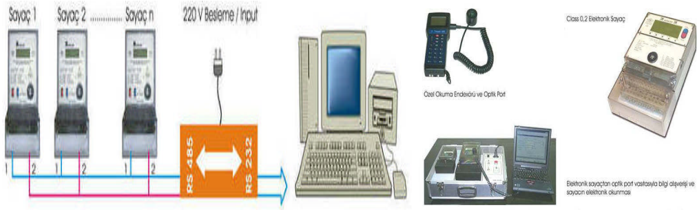
Şekil 3.21: RS 485 port üzerinden ve optik port ile sayaç okuma sistemi
