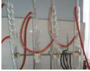
Resim 1.14: Su hortumlarının bağlanması
