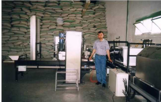
Resim 1.29: Otomatik tohum ekme makinesi
