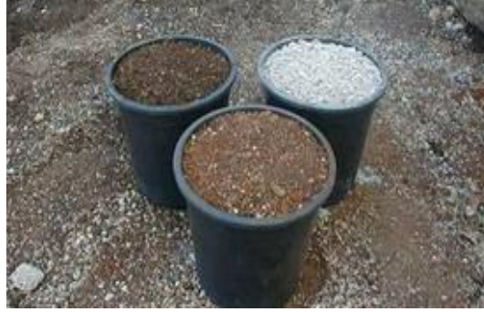
Resim 1.10: Harç materyallerinin karıştırma oranları (1-1-1 ölçüsü)
