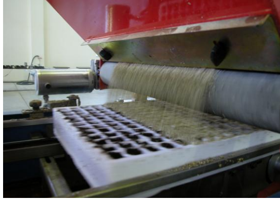
Resim 1.30: Otomatik makinede viyol dolumu
