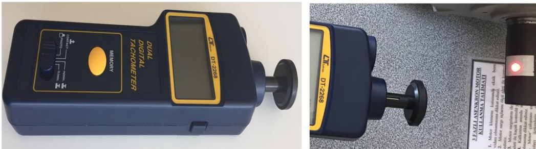
Resim 3.3: Dijital takometre ölçüm butonu ve reflektör bant
