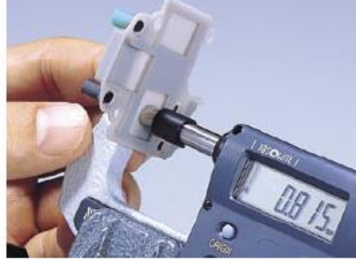
Resim 2.4: Dijital mikrometre ile değişik parçaların çap ölçümü
