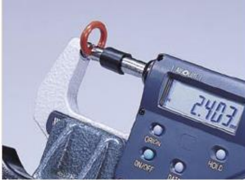
Resim 2.4: Dijital mikrometre ile değişik parçaların çap ölçümü
