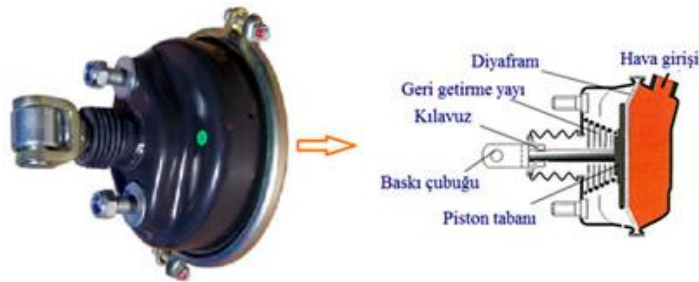
Şekil 9.19: Pistonlu tip ve diyaframlı tip hava körüğü
