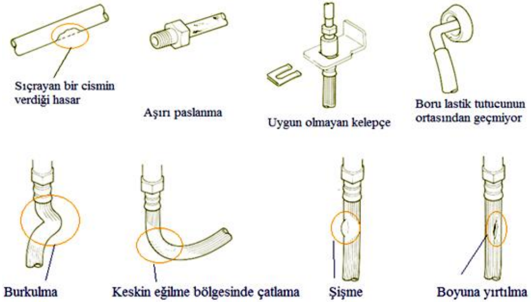
Şekil 5.2: Boru ve hortum arızaları
