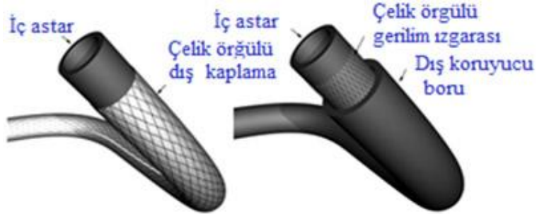
Şekil 5.1: Fren hortumlarının iç yapısı
