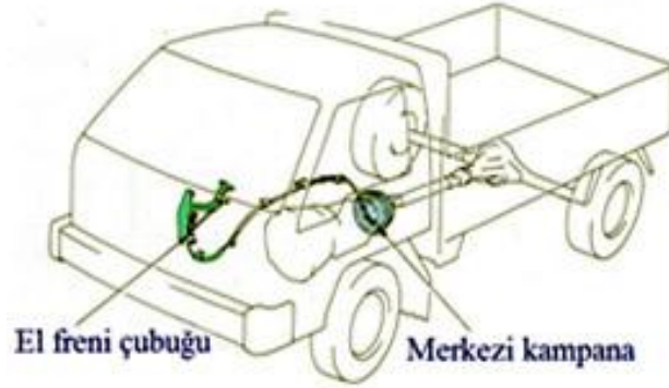
Şekil 7.3: Transmisyon çıkış mili üzerine yerleştirilen el freni
