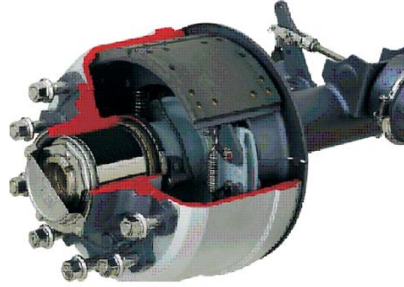
Resim 9.5: Kampanalı havalı fren sistemi
