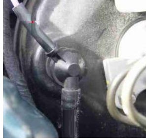
Resim 4.3: Fren vakum hortumu ve hidrovaka bağlantısı
