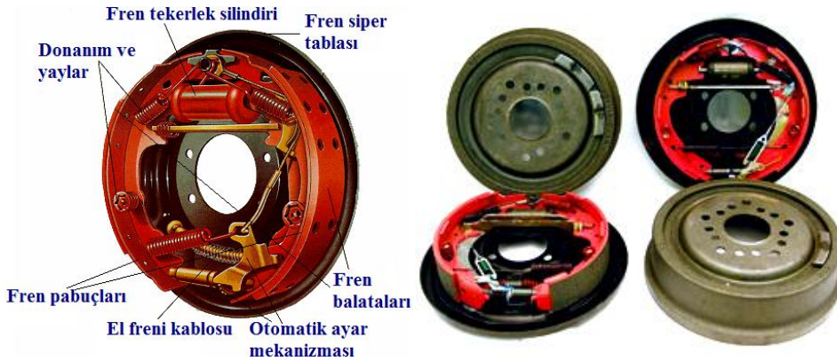
Resim 2.1: Kampanalı tekerlek fren sistemi
