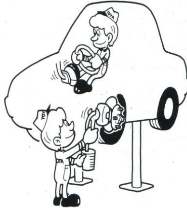
Şekil 3.9: Fren havasının alınması
