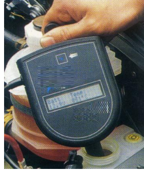
Resim 3.2: Fren hidroliğinin kaynama noktasının ölçülmesi
