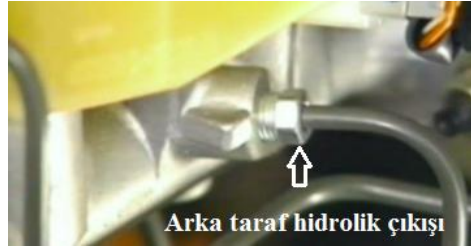
Resim 3.5: Fren merkez pompası arka hidrolik çıkış rekoru
