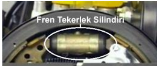
Resim 2.2: Fren tekerlek silindirinin araç üzerindeki yeri
