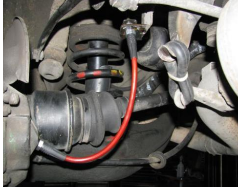
Resim 5.6: Ön fren kaliperine fren hortumu bağlantısı
