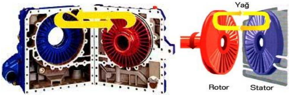
Şekil 6.1: Hidrodinamik retarder yapısı
