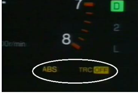
Resim 2.9: ABS sistemi arızalıysa patinaj kontrol sisteminin devre dışı kalma uyarısı
