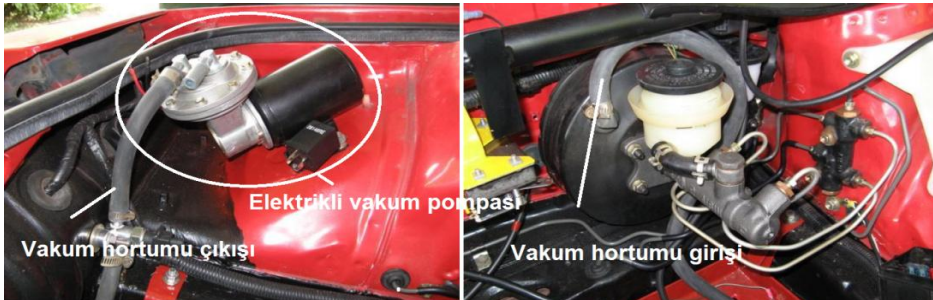
Resim 5.3: Vakum pompasının fren sisteminin ihtiyaç duyduğu vakumu karşılaması
