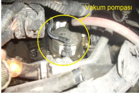
Resim 5.2: Mekanik vakum pompasının araç üzerindeki yeri
