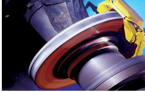
Resim 6.2: Retardersiz balata ve disklerin ısınarak kızarması
