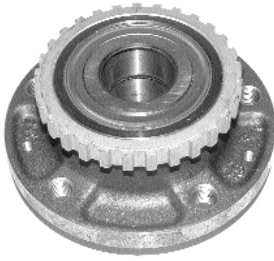
Resim 1.4: Diskli ve kampanalı arka frenlerde kullanılan dişli rotorlar
