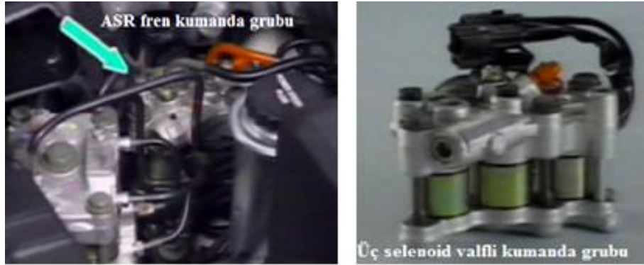
Resim 2.7: Patinaj kontrol sistemi fren kumanda grubunun araç üzerindeki yeri
