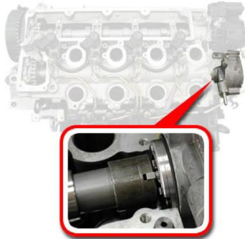
Şekil 5.5: Mekanik vakum pompasının motordan hareket alışı şekli
