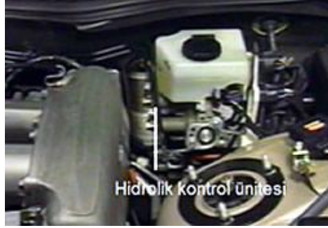
Resim 3.8: Hidrolik kontrol ünitesi
