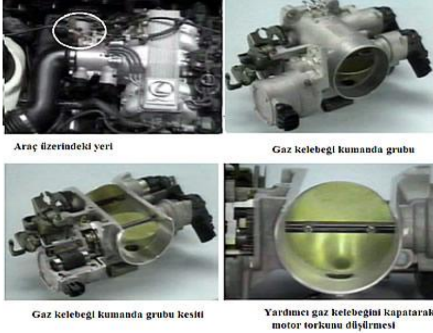
Resim 2.4: Motor torkunu kontrol eden kumanda grubu
