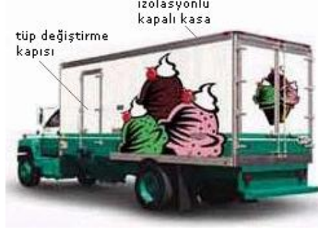
Resim 2.2: Dondurucu sıvı kullanarak soğutmanın sağlandığı kamyon
