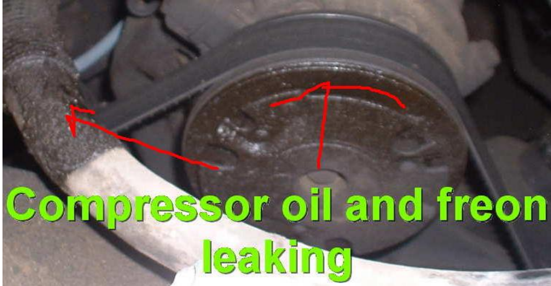
Resim 1.6: Mekanik contasından yağ ve gaz kaçağının kavrama ve hortum üzerinde bıraktığı iz
