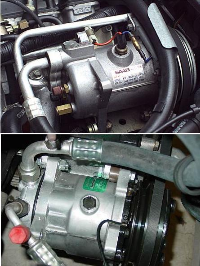
Resim 1.3: Açık tip araç soğutma kompresörleri ve devre bağlantıları
