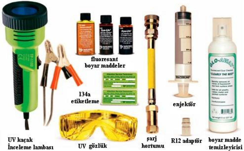
Resim 1.9: Frigorifik araç ve araç klimalarında soğutucu akışkan kaçağını aramada kullanılan araç ve gereçlerden örnekler
