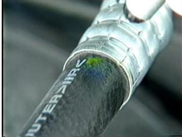
Resim 1.8: Hortumda soğutucu akışkan kaçağı
