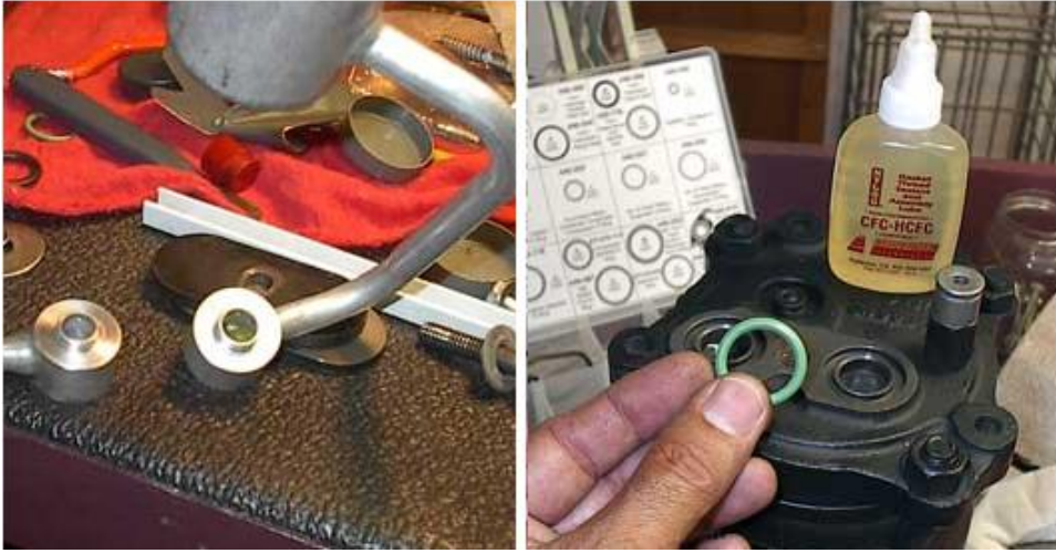
Resim 1.1: Conta kaynaklı soğutucu akışkan sızıntısı olma ihtimali, Conta ve hızlı servis adaptörlerine örnekler
