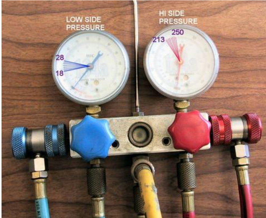
Resim 5.3: Çalışma halindeki otomobil klimasının normal basınç değerleri
