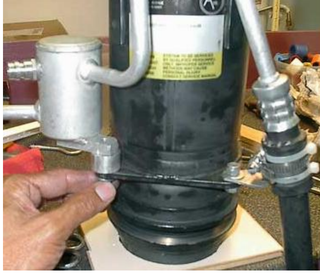
Arızalı manyetik kavrama bobininin değiştirilmesi
