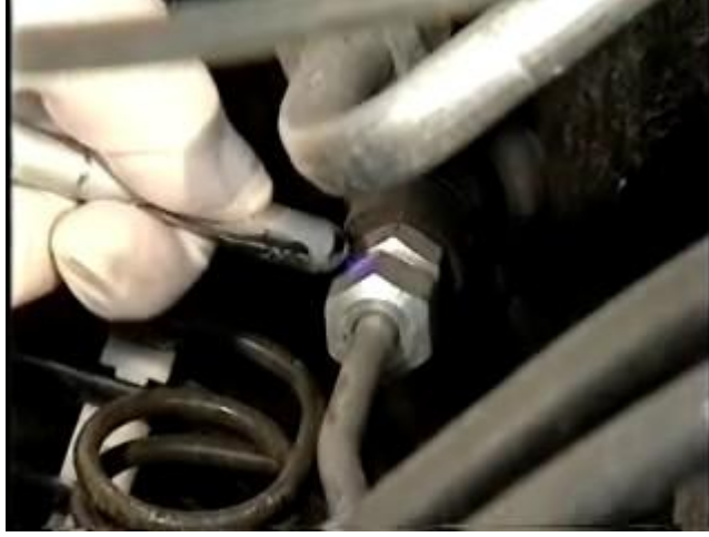
Resim 1.7: Rakorda soğutucu akışkan kaçağı
