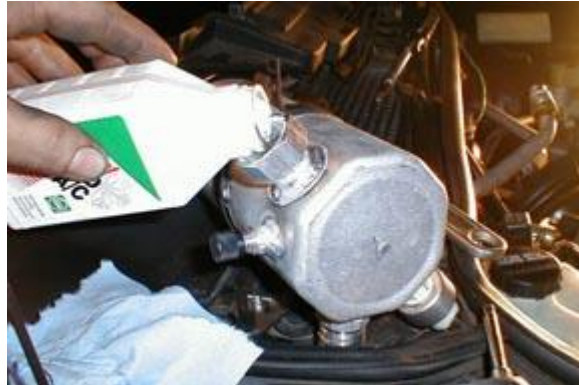
Resim 2.1: Kompresöre yağlama yağı ilavesi
