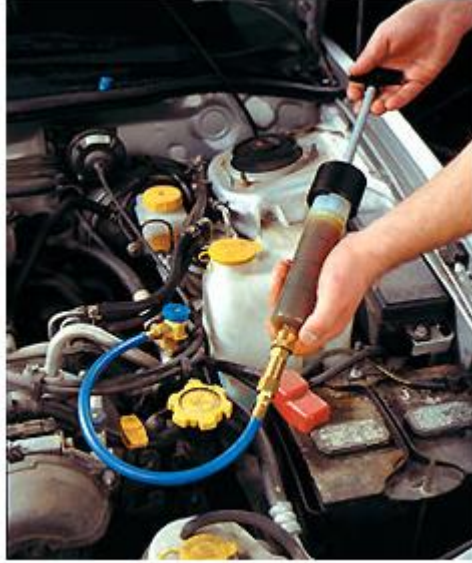
Resim 1.12: Boyar maddenin soğutma sistemine ilavesi
