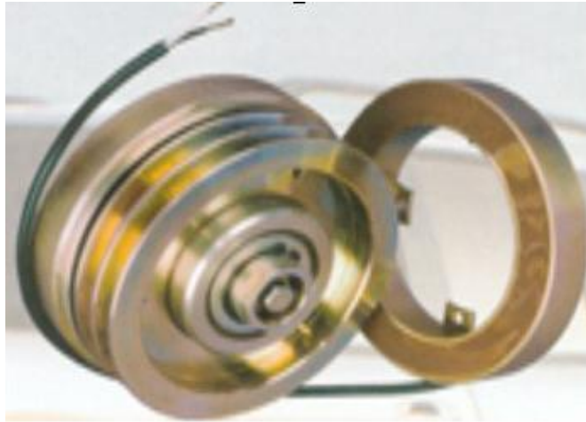
Resim 3.4: Manyetik kavrama, kasnak ve bobin
