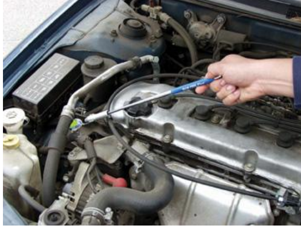
Resim 1.13: Erişilemeyen noktalarda ayna ile kaçak aranması
