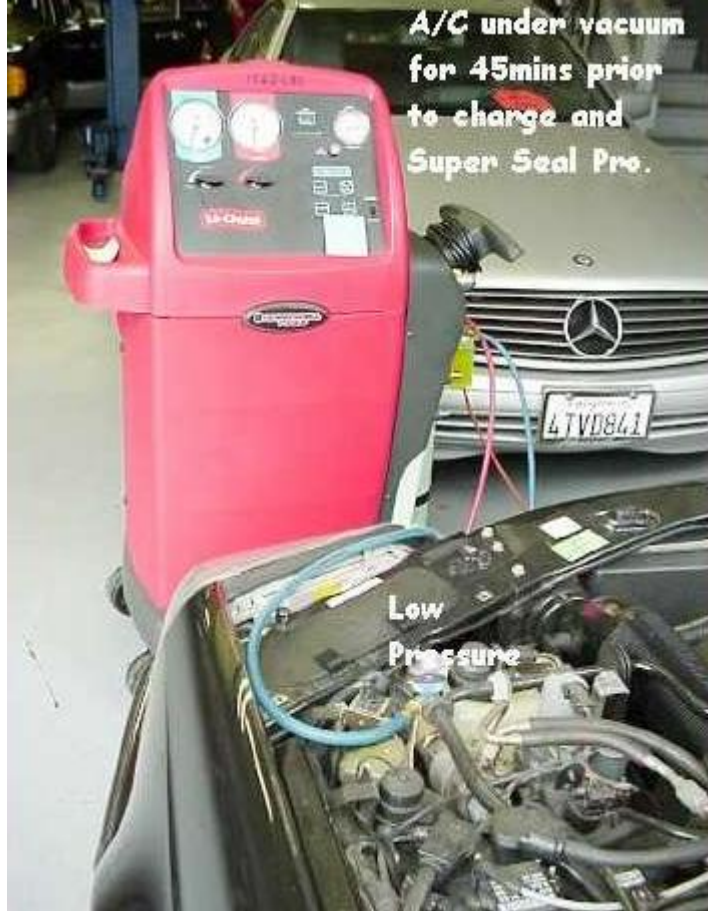
Resim 1.4: Araç klimasında servis öncesi soğutucu gazın arındırma cihazında toplanması
