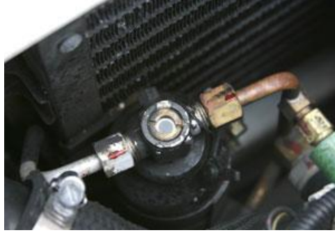
Resim 2.15: Frigorifik ve araç klimalarının soğutma sisteminde kullanılan gözetleme camı sistemin genel durumu hakkında daha sağlıklı bilgi sahibi olmamızı sağlaması
