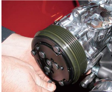
Resim 1.13: Kompresör kavraması sıkılığının sentille kontrolü
