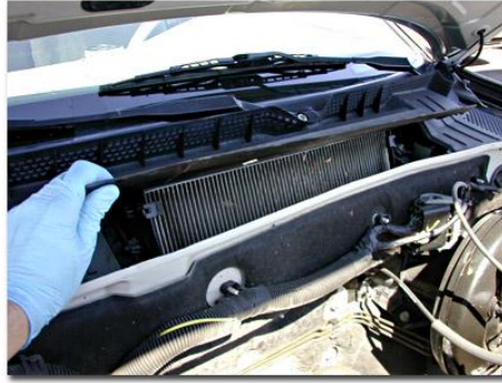
Resim 1.9: Aracın ön göğüslüğüne davlumbaz içine yerleştirilmiş evaporatör
