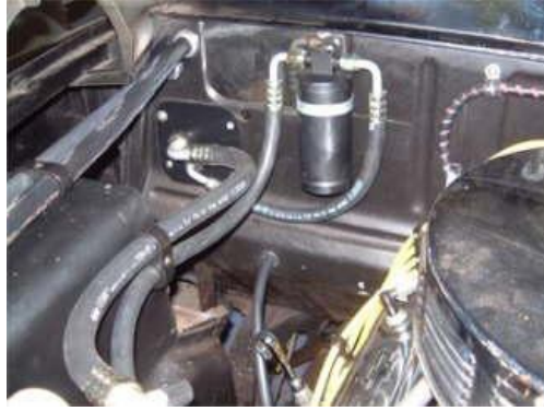
Resim 2.18: Filtre-kurutucunun otomobil klimasındaki konumu
