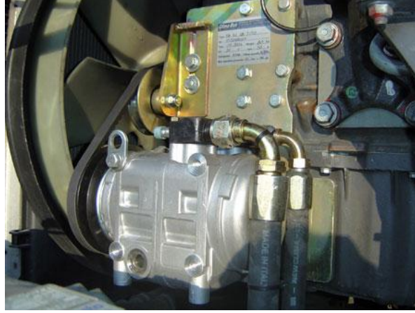
Resim 2.13: Bakımda tüm bağlantılar boru ve hortum devresinin gözden geçirilmesi
