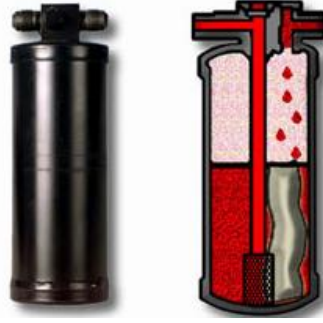
Resim 2.19: Otomobil klimalarında kullanılan filtre-kurutucunun yapısı
