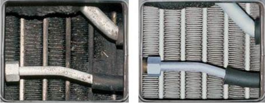
Resim 1.11: Otomobil klimalarında kullanılan kirlenmiş bir evaporatör ve temizlik sonrası görünümü
