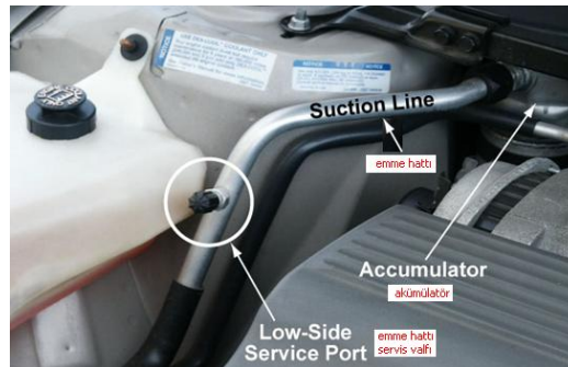
Resim 2.21: Otomobil klimasında akümülatörün devre üzerindeki konumu
