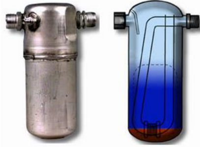
Resim 2.22: Otomobil klimalarında kullanılan emme akümülatörünün yapısı
