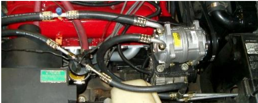
Resim 1.3: Otomobil kliması (kompresör, servis valfleri, filtre-kurutucu ve hortumlar)
