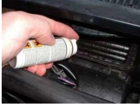
Resim 1.12: Otomobil klimalarında kirlenmiş bir evaporatörden kaynaklanan kötü kokuların giderilmesinde kullanılan bakteri ve küf oluşumunu engelleyici kimyasal uygulaması
