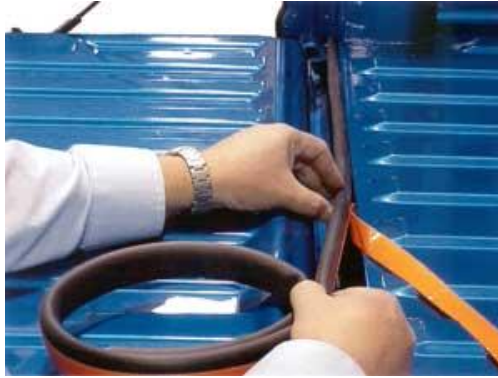
Resim 2.42: Sızdırmazlık sağlayan kapı fitillerinin yenilenmesi
