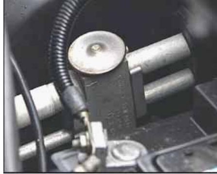
Resim 2.23: Otomobil klimalarında kullanılan TGV
