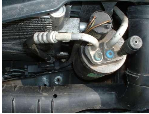
Resim 2.33: Alçak basınç hattında akümülatör üzerinde kullanılan basınç sensörü (basınç presostatı)
