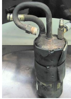
Resim 2.20: Otomobil klimasında korozyona uğramış akümülatör
