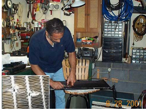
Resim 1.8: Kondenser finlerinin (kanatçıklarının) düzeltilmesi ve kondenser tamiri
