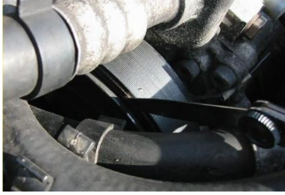
Resim 2.37: Manyetik kavrama sıklığının filer çakısı (sentil) ile ayarlanması
