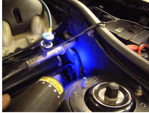
Resim 2.11: UV ışık ile klima devresinde soğutucu akışkan kaçak yerinin aranması
