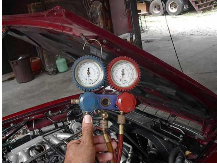
Resim 1.5: Klima soğutma sisteminin basınç değerlerinin ölçülmesi
