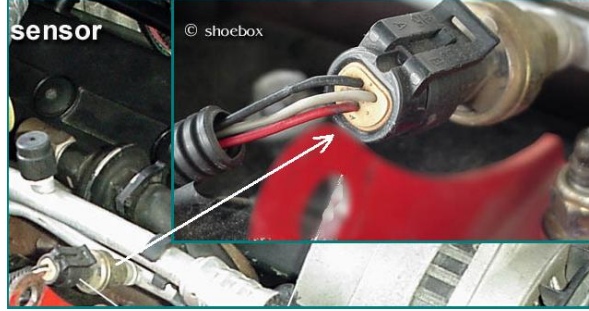
Resim 2.32: Yüksek basınç hattında kullanılan basınç sensörü (basınç presostatı)
