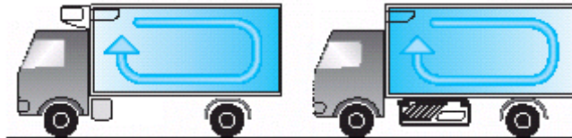
Şekil 1.19 : Monoblok ve split frigorifik uygulamalar
