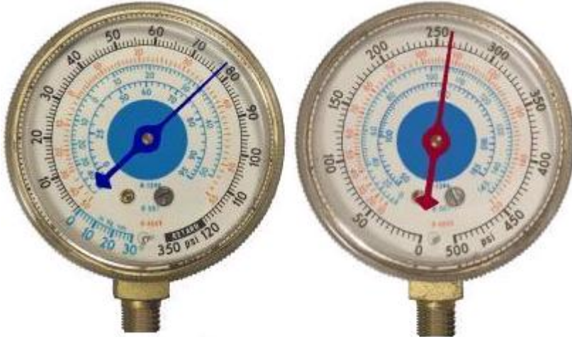
Resim 3.11 : Alçak basınç ve vakum (kombine) manometresi (solda) yüksek basınç manometresi (sağda)
