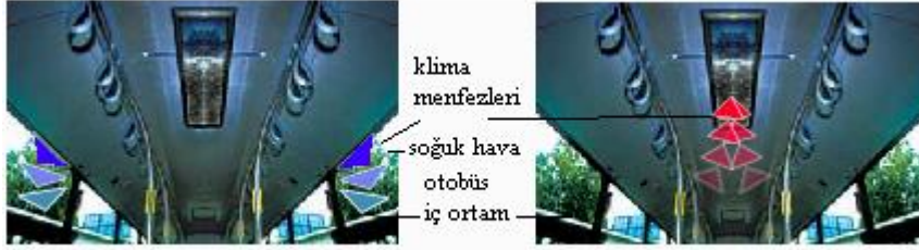
Şekil 1.11 : Otobüs kabin içi klima menfezleri ve hava hareketi
