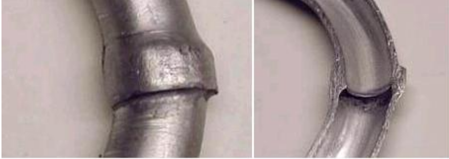
Resim 2.7 : Oksi-gaz kaynağı kullanılarak kaynatılmış alüminyum borular
