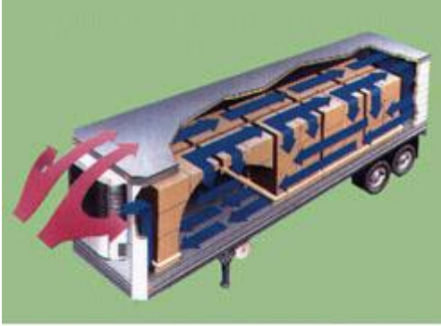
Şekil 1.14 : Monoblok soğutma sisteminin kullanıldığı frigorifik konteyner
