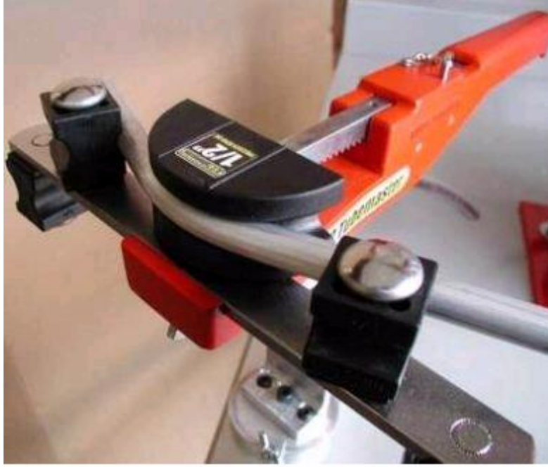
Resim 2.3 : Alüminyum ve çelik boruları bükmede kullanılan boru bükme aparatı (3/8", 1/2", 5/8" ve 3/4")
