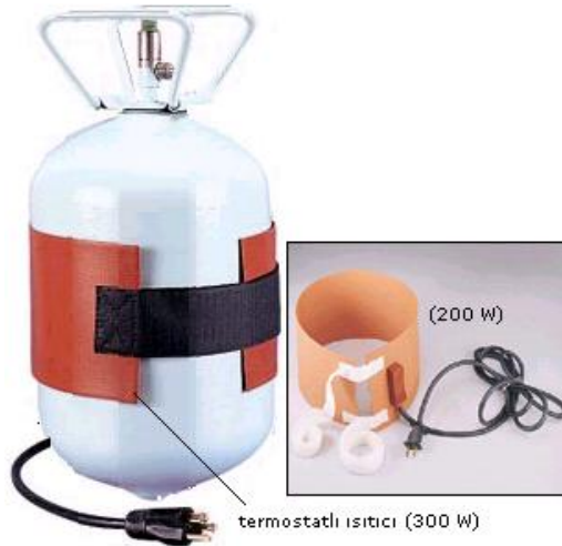
Resim 3.10 : Soğutucu akışkan şarjında sürekli gaz akışını sağlamak üzere tüp gövdesine sarılarak kullanılan ısıtıcı
