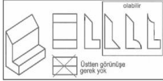
Şekil 1.31: İki Görünüşün Seçilmesi
