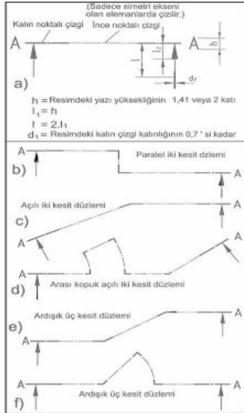
Şekil 2.3: Kesit Düzleminin Görünüşlerde Kesit Çizgisi Olarak Gösterilmesi
