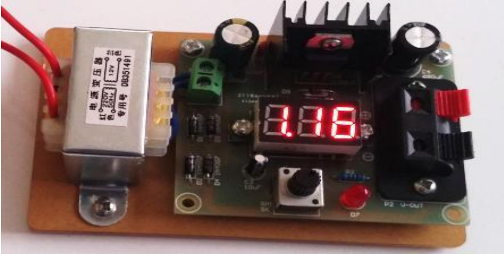
Fotoğraf 4.13: Güç kaynağı-2 devresinin enerji kablosu takıldığında voltmetre görüntüsü (pot minimumda)
