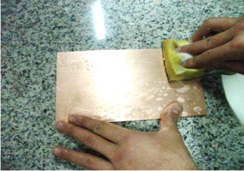
Fotoğraf 2.10: Baskı devre plaketinin yüzeyinin temizlenmesi
