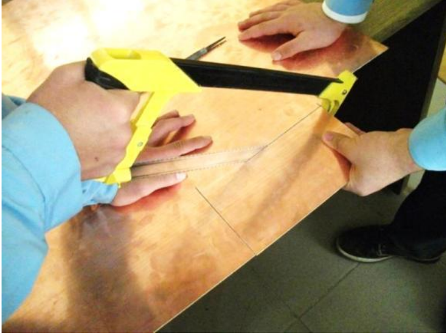
Fotoğraf 2.9: Baskı devre plaketinin testere ile kesilmesi
