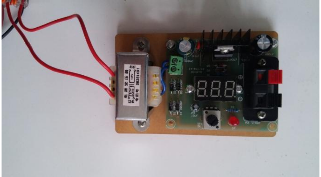
Fotoğraf 3.7: Güç kaynağı 2 transformörün tablaya montajı
