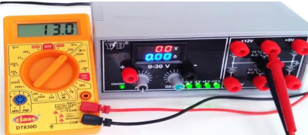
Fotoğraf 4.11: Güç kaynağı-1, sabit AC 12V 0V ucundan ölçülen gerilim değeri
