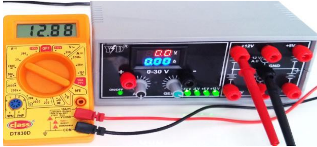
Fotoğraf 4.10: Güç kaynağı-1, sabit +12V 0V ucundan ölçülen gerilim değeri
