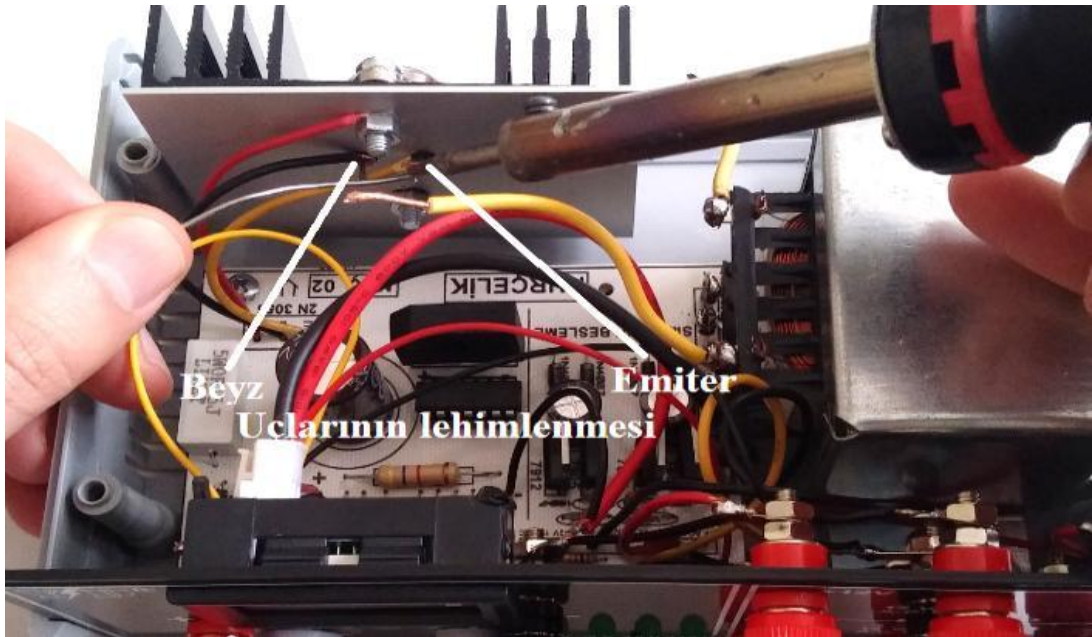
Fotoğraf 3.24: Güç kaynağı-1, 2N3055 transistörün beyz ve emiter uçlarının lehimlenmesi
