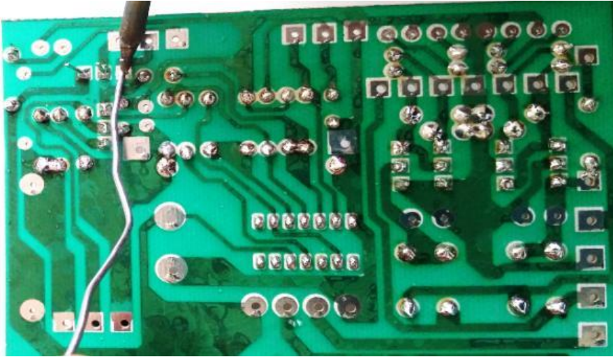
Fotoğraf 2.51: Güç kaynağı-1, transistörlerin lehimlenmesi
