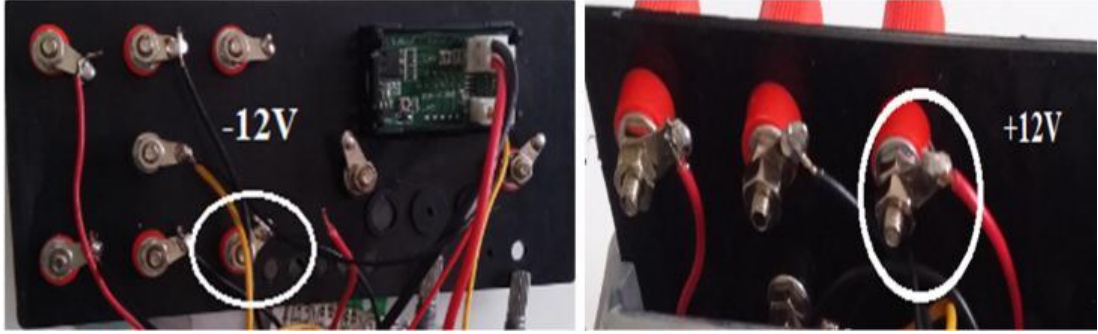
Fotoğraf 3.16: Güç kaynağı-1, born vidalarına kabloların lehimlenmesi
