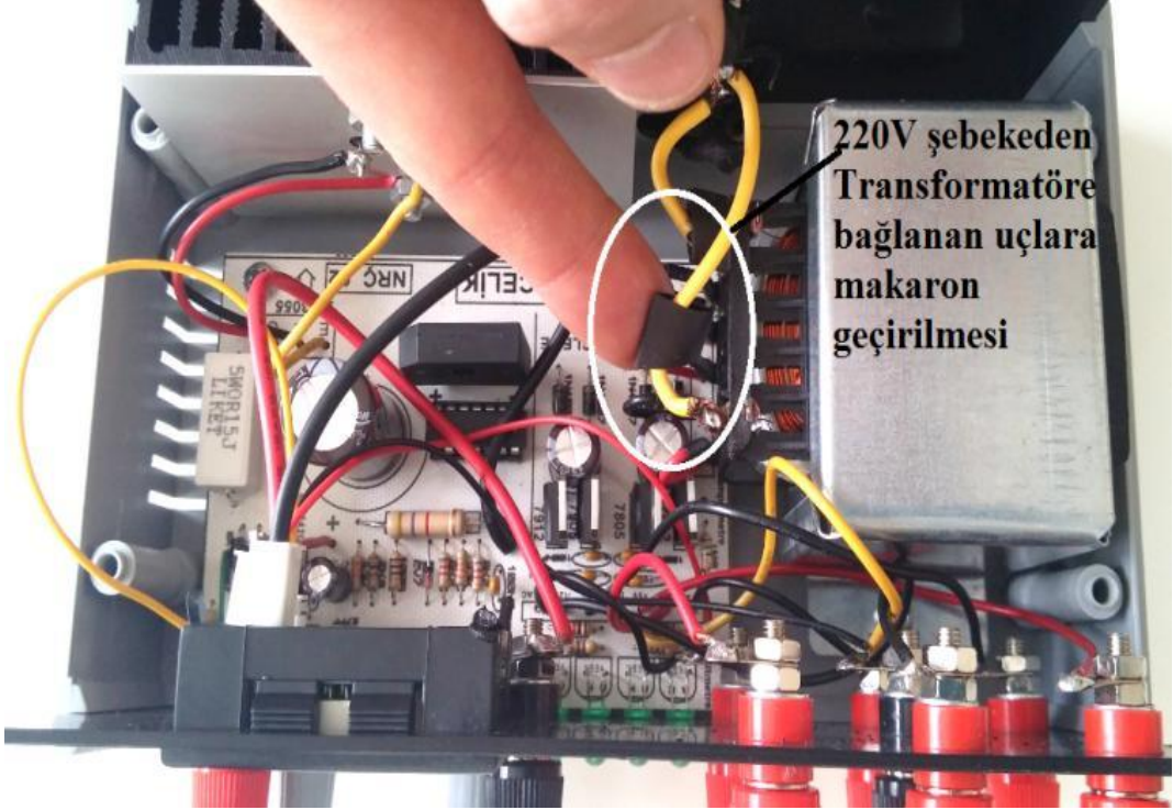
Fotoğraf 3.4: Güç kaynağı-1, transformatör uçlarına 220 V şebeke geriliminin bağlanması
