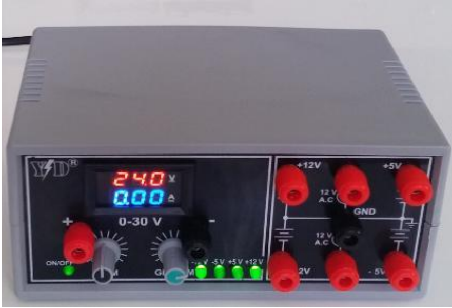
Fotoğraf 4.2: Testi yapılacak güç kaynağı-1
