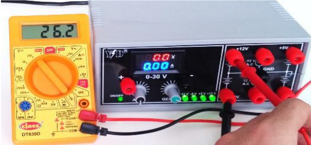
Fotoğraf 4.7: Güç kaynağı-1, sabit +12V -12V ucundan ölçülen gerilim değeri
