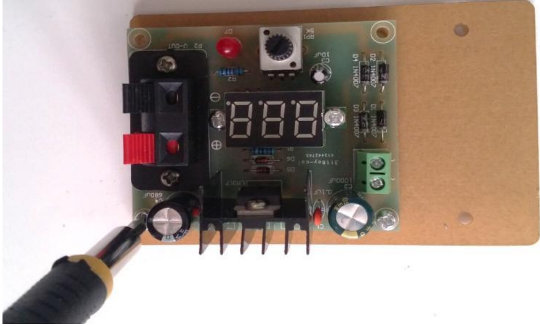
Fotoğraf 3.9: Güç kaynağı-2 elektronik kartın tablaya montajı
