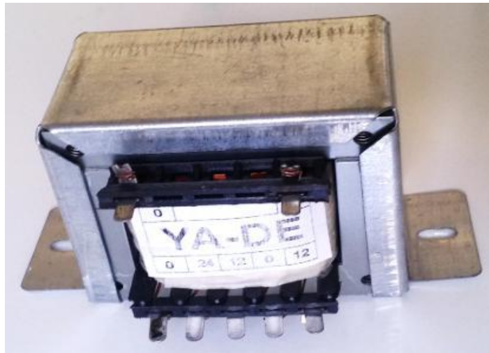
Fotoğraf 1.8: AC 0-24V 2x12V çıkışlı transformatör
