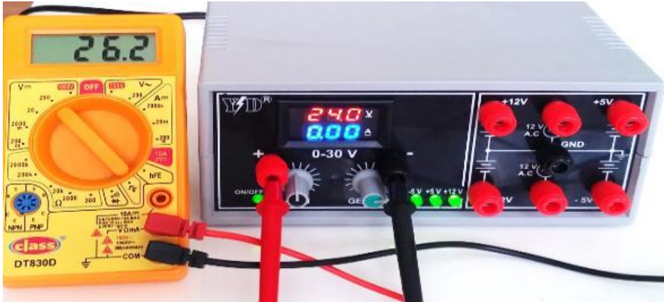
Fotoğraf 4.5: Güç kaynağı-1, ayarlı DC 24V ucundan ölçülen gerilim değeri
