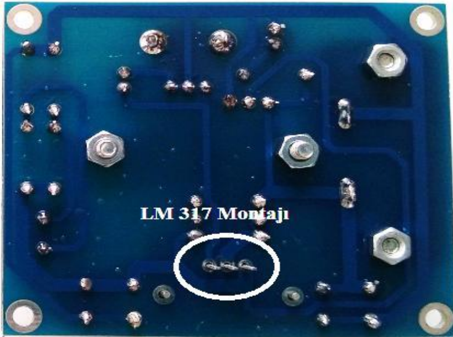
Fotoğraf 2.76: Güç kaynağı-2 LM317 entegre ve soğutucunun montajı
