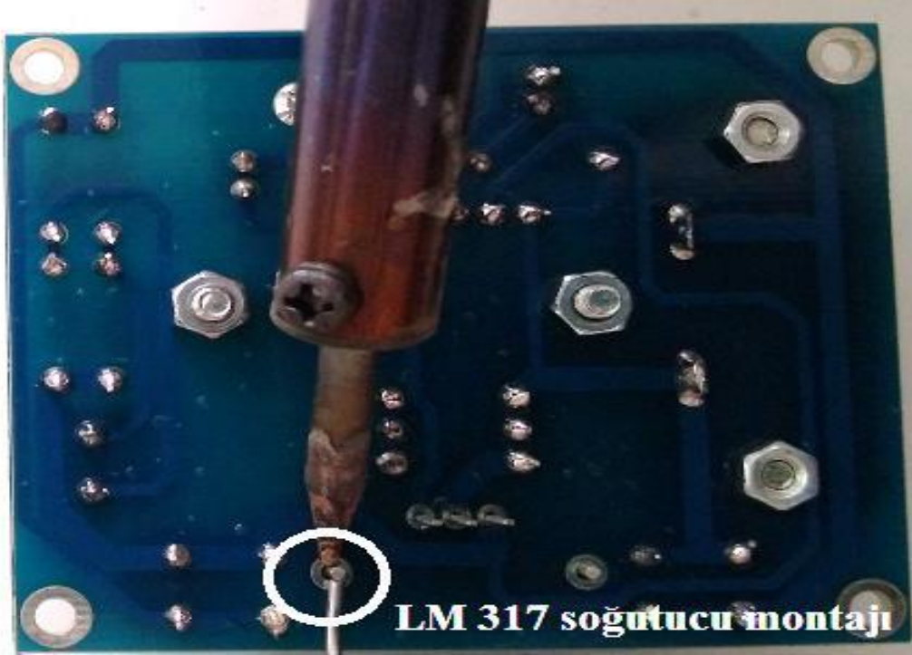
Fotoğraf 2.78: Güç kaynağı-2 LM 317 soğutucusunun montajı ve lehimlenmesi
