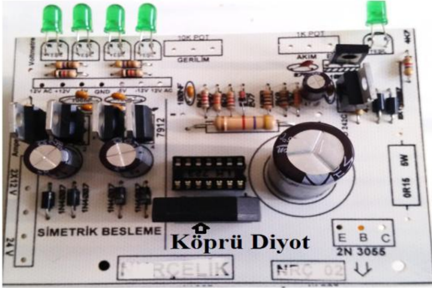
Fotoğraf 2.63: Güç kaynağı-1, köprü diyotun plakete yerleşimi
