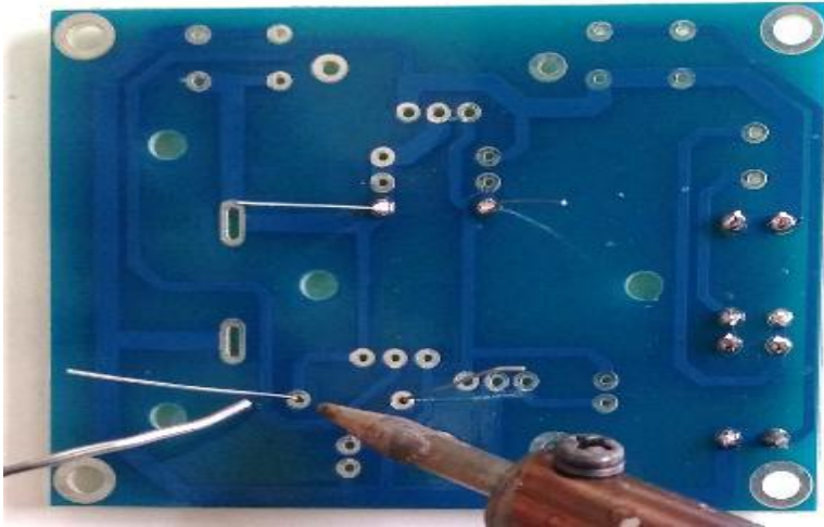
Fotoğraf 2.32: Güç kaynağı-2 devresinde dirençlerin plaket üzerindeki yerleşimi
