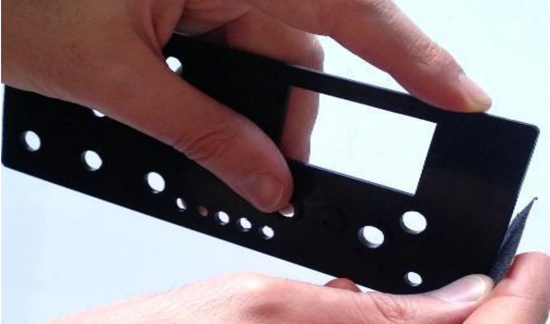
Fotoğraf 1.13: Ön panelin deliklerinin ve kenarlarının zımparalanması
