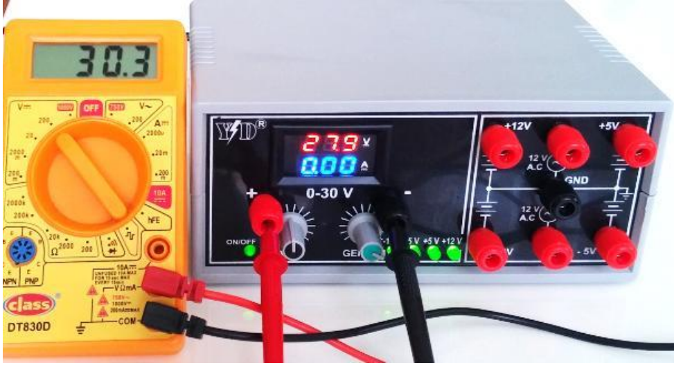
Fotoğraf 4.4: Güç kaynağı-1, ayalı gerilim bölümünün en yüksek gerilim değeri
