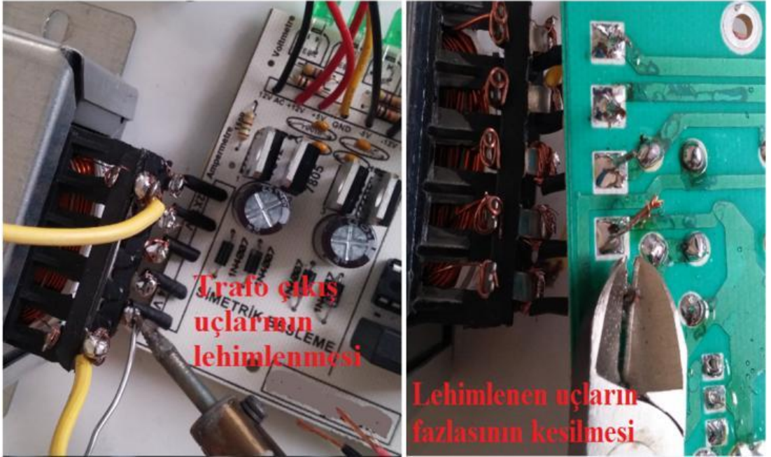
Fotoğraf 3.2: Güç kaynağı 1, transformatöre uçların bağlanması
