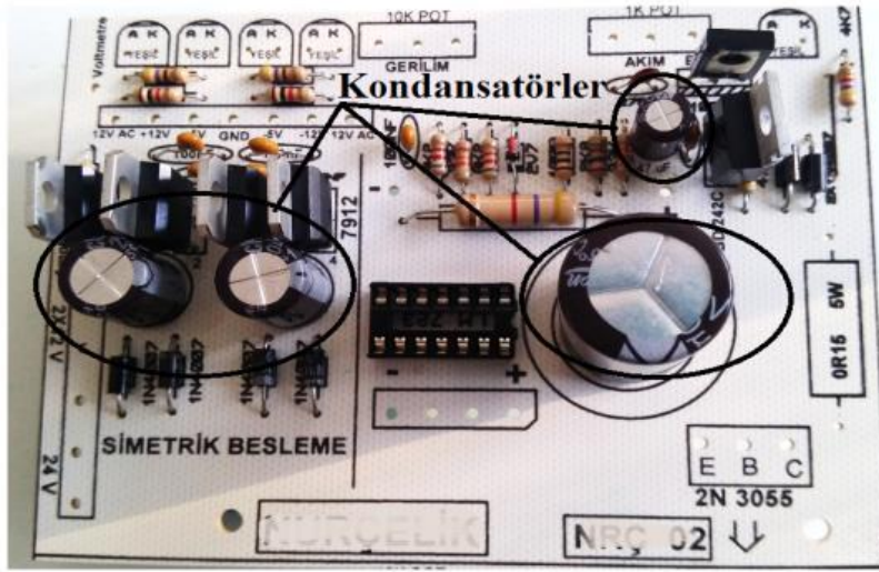
Fotoğraf 2.53: Güç kaynağı-1, elektrolitik kondansatörlerin plakete yerleşimi
