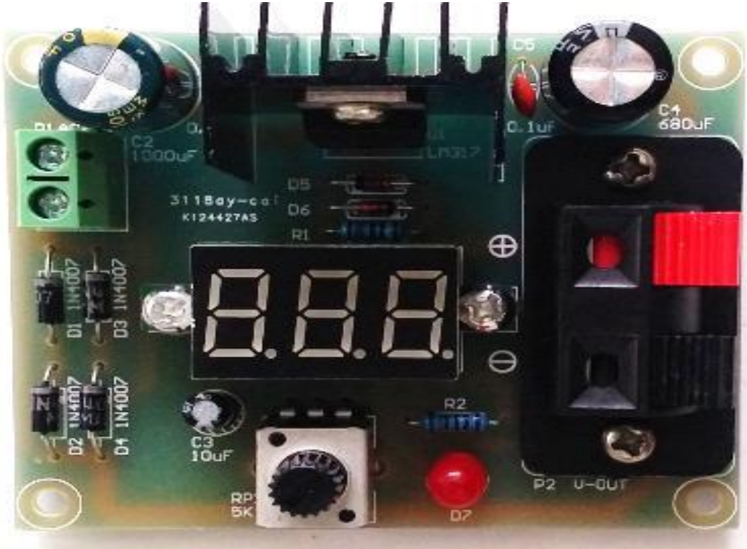
Fotoğraf 2.76: Güç kaynağı-2 LM317 entegre ve soğutucunun montajı
