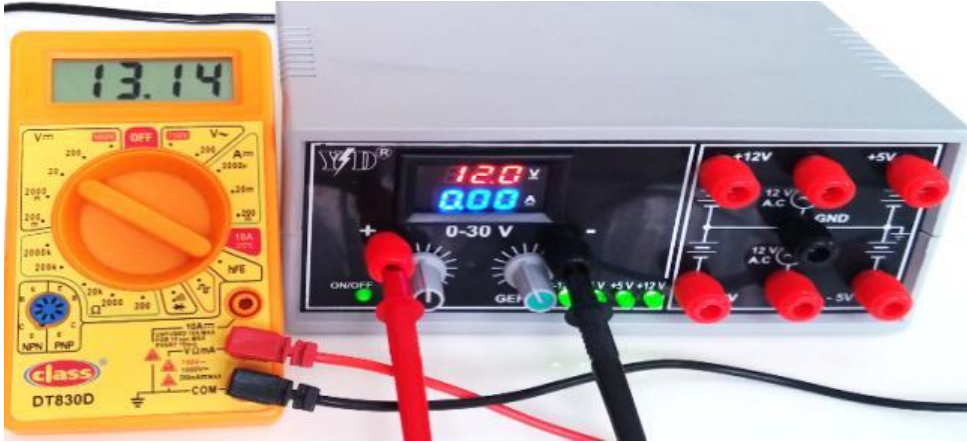
Fotoğraf 4.6: Güç kaynağı-1, ayarlı DC 12V ucundan ölçülen gerilim değeri
