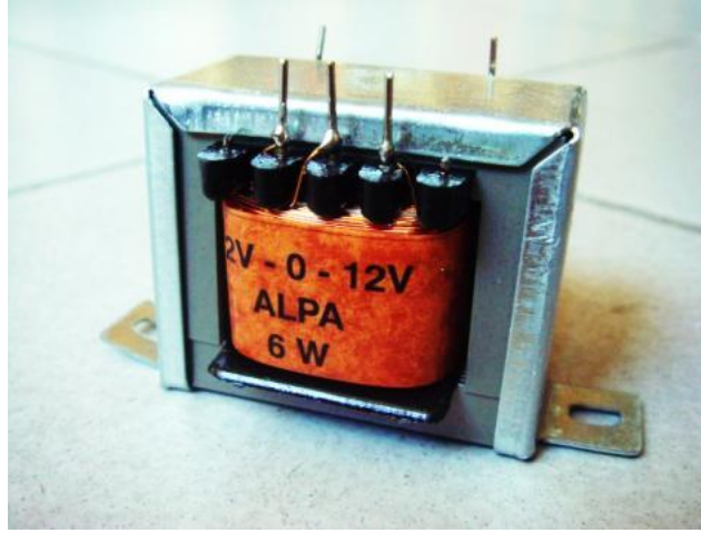
Fotoğraf 1.7: 6W ve AC 2x12V transformatör
