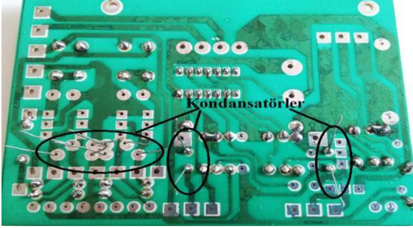
Fotoğraf 2.42: Güç kaynağı-1, mercimek kondansatörlerin lehimlenmesi
