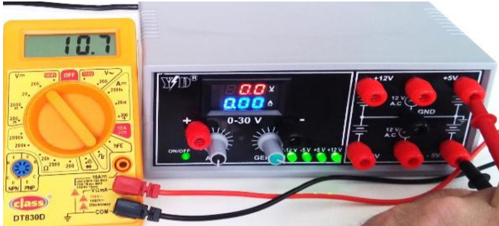
Fotoğraf 4.8: Güç kaynağı-1, sabit +5V -5V ucundan ölçülen gerilim değeri
