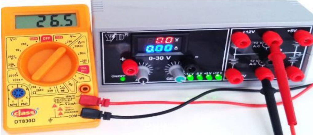
Fotoğraf 4.12: Güç kaynağı-1, sabit AC 12V AC 12V ucundan ölçülen gerilim değeri
