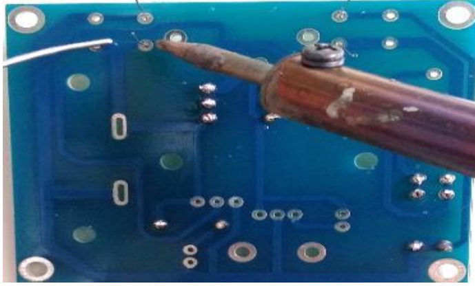
Fotoğraf 2.44: Güç kaynağı-2 devresinde mercimek kondansatörlerin lehimlenmesi
