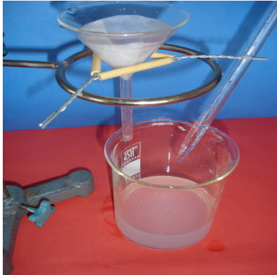
Resim 2.13: Süzüntü kontrolü yapma
