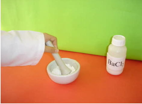
Resim 1.14: Numuneyi homojenize etme
