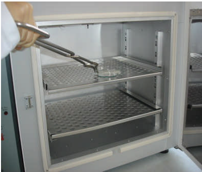
Resim 1.16: Numuneyi etüvde kurutma
