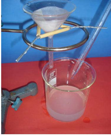
Resim 1.31: Süzüntü kontrolü yapma
