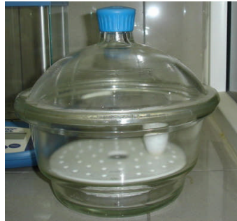
Resim 1.13: Krozeyi desikatörde soğutma
