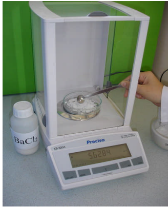
Resim 1.15: Homojenize numuneden tartma
