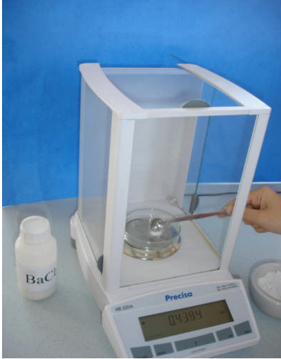
Resim 1.18: Sođutulmuş numuneyi tartma
