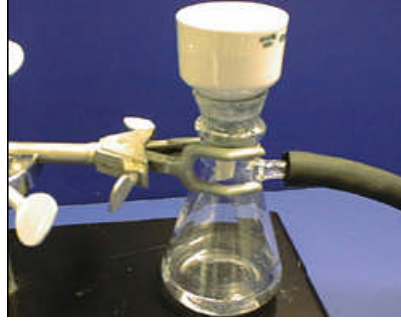
Resim 1.11: Vakumlu süzme düzeneği
