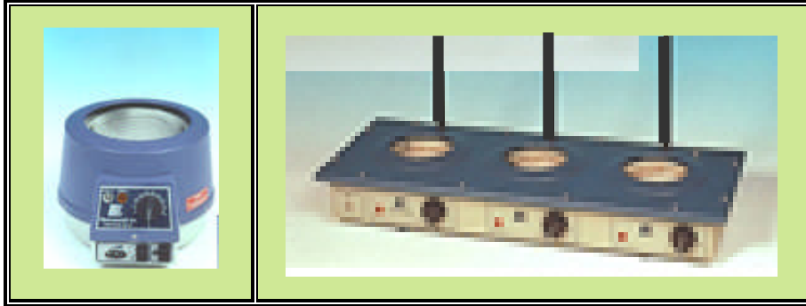
Resim 1. 4: Klasik Kjeldahl yönteminde kullanılan yakma düzenekleri
