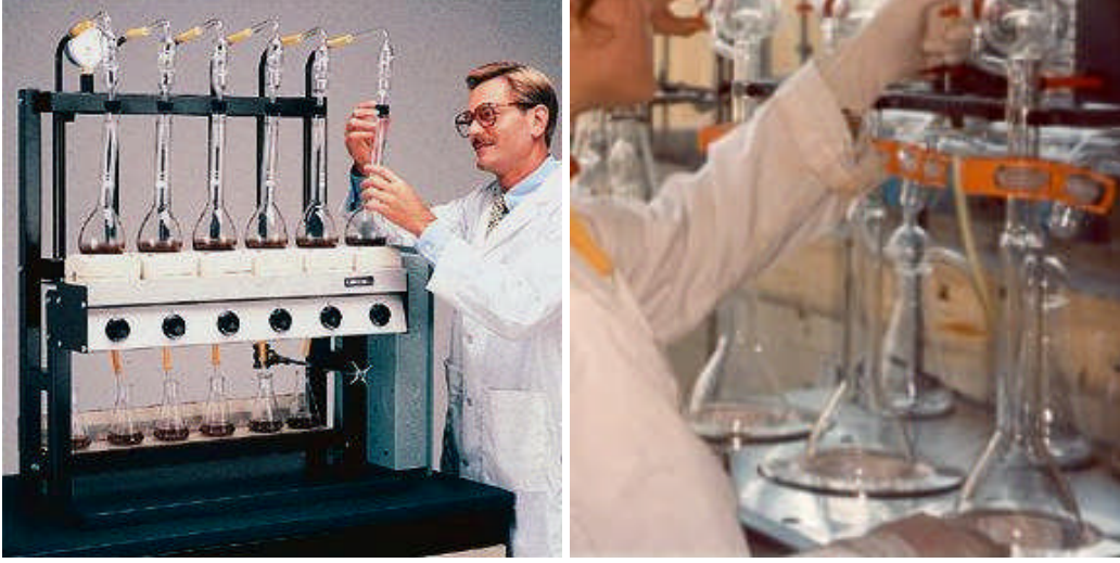
Resim 2. 2: Klasik Makro Kjeldahl yönteminde kullanılan damıtma düzeneğinin hazırlanması.
