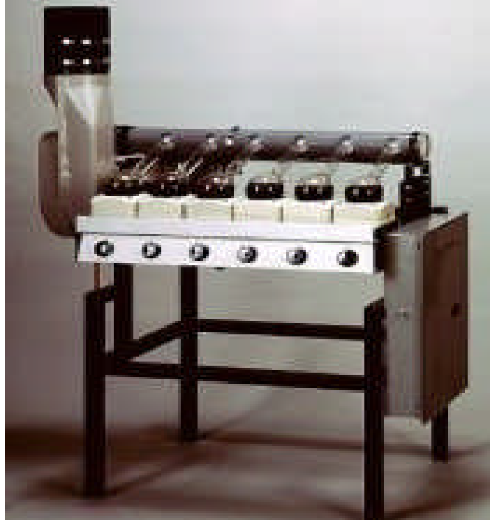
Resim 1. 8: Klasik Makro Kjeldahl yönteminde kullanılan yakma düzeneği
