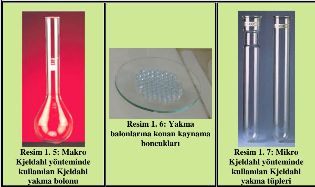
Resim 1. 4: Klasik Kjeldahl yönteminde kullanılan yakma düzenekleri
