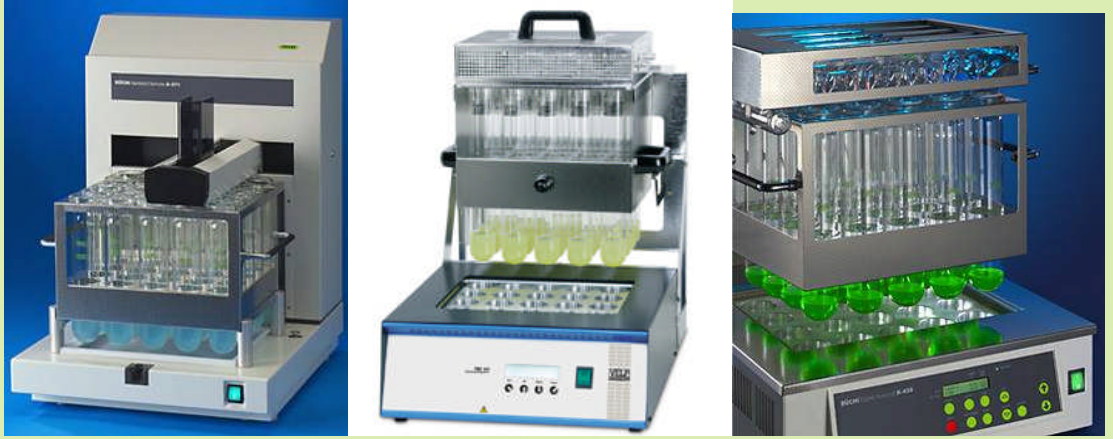
Resim 1. 9: Mikro Kjeldahl yönteminde kullanılan yakma düzenekleri ve yakma bitiminde oluşan renkler.
