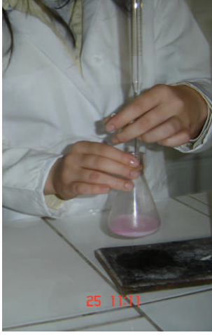
Resim 3.14: Faktörü belli olan 0.1 N NaOH ile titre etme
