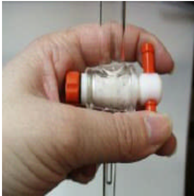
Resim 3. 4: Titrasyonda büret musluğu kontrolü
