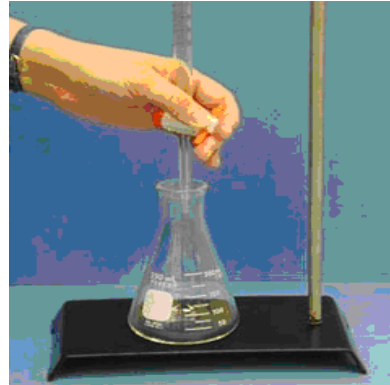
Resim 3. 4: Titrasyonda büret musluğu kontrolü
