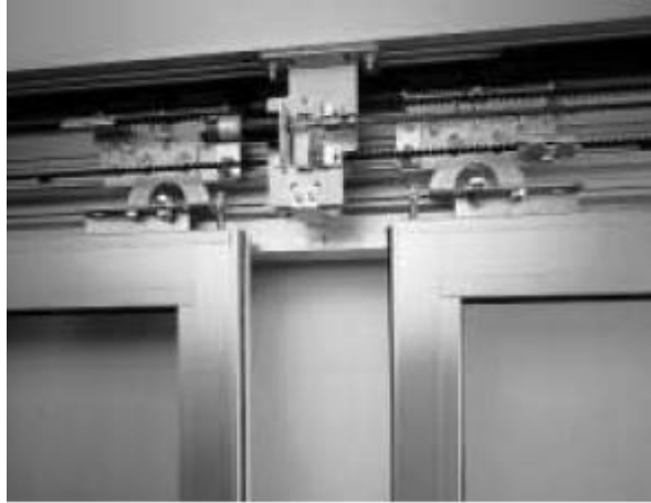
Resim 1.22: Cam yana açılır kapı üst sürgü düzenneđi
