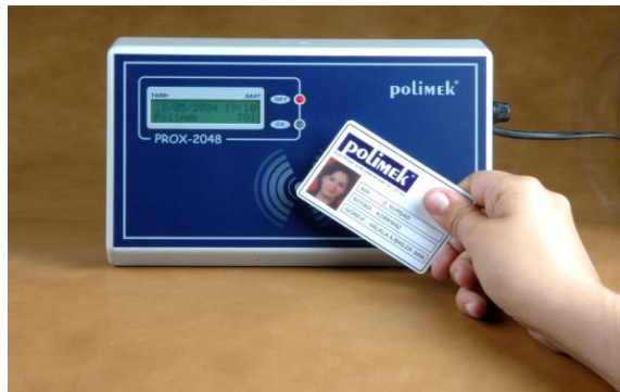
Resim 3.13: Kartlı geçiş sisteminde reader ve proximity kart
