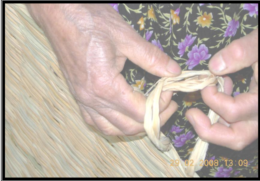
Resim 2.10: Hasır başlangıcındaki çözügelerin örülmesi
