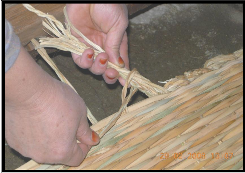
Resim 2.5: Çözü iplerinin düğümlenmesi
