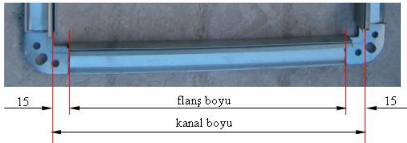
Resim 1.15: Flanş uzunluğunun hesaplanması
