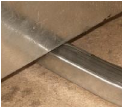
Resim 4.11: C profile conta takılmış hâlde kanalın profile basması
