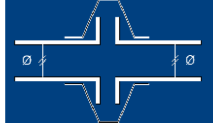
Şekil 2.6: Kelepçe ekleme detayı
