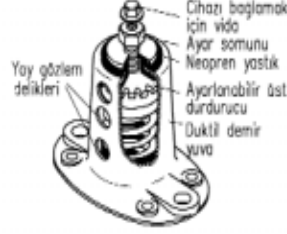
C Tipi Sismik sınırlayıcı takoz
