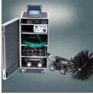
Resim 2.10: Kanal içi görüntü alma ve temizleme robotu
