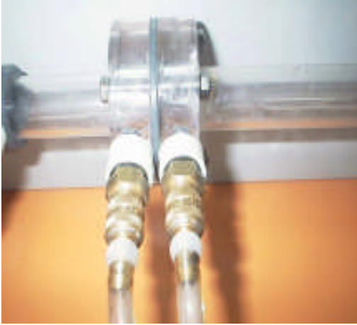
Resim 3.10: Orifis plakası (test düzeneği)
