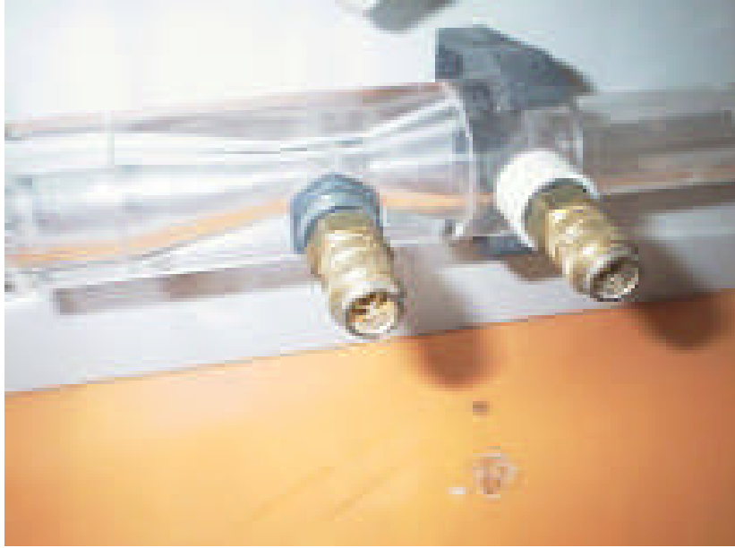
Resim 3.12: Montajı yapılmış ventürimetre (test düzeneği)
