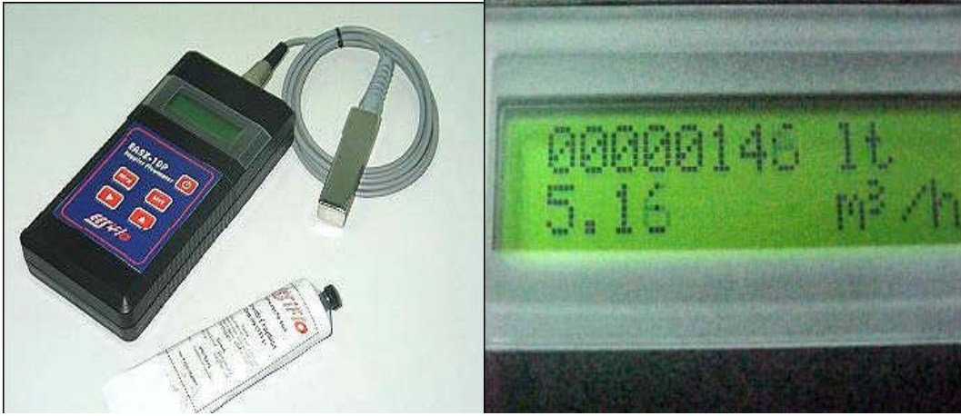
Resim 3.13: Taşınabilir ultrasonik akış ölçer
