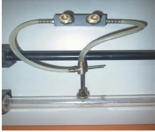
Resim 3.9:Pitot tüpü (test düzeneği)
