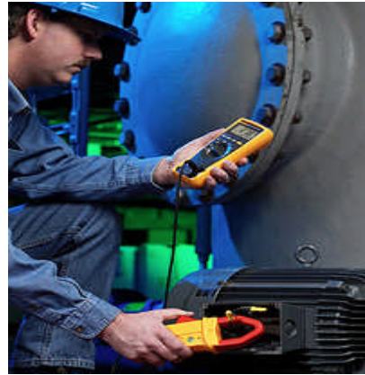
Resim 1.5: Pens ampermetre ile lm yapma
