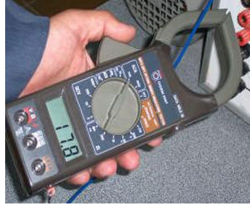
Resim 1.4: Pens ampermetre ile lm yapma
