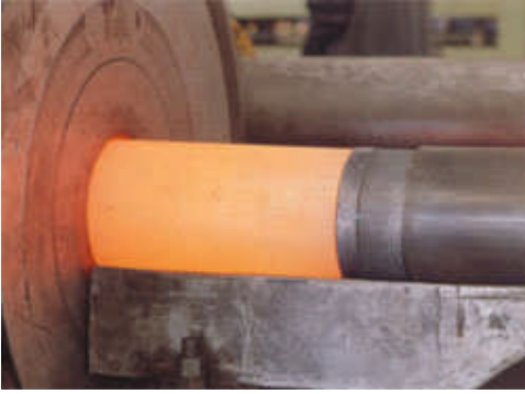
Resim 4.7: Bakır borunun haddede çekimi
