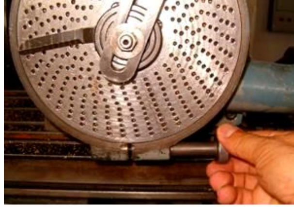
Resim 1.2: Tespit vidasının gösterilmesi
