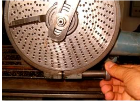
Resim 1.1. Sıkma vidasının gösterilmesi
