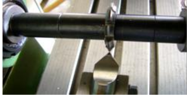
Resim 1.3: İş ekseninin freze eksenine ayarlanması
