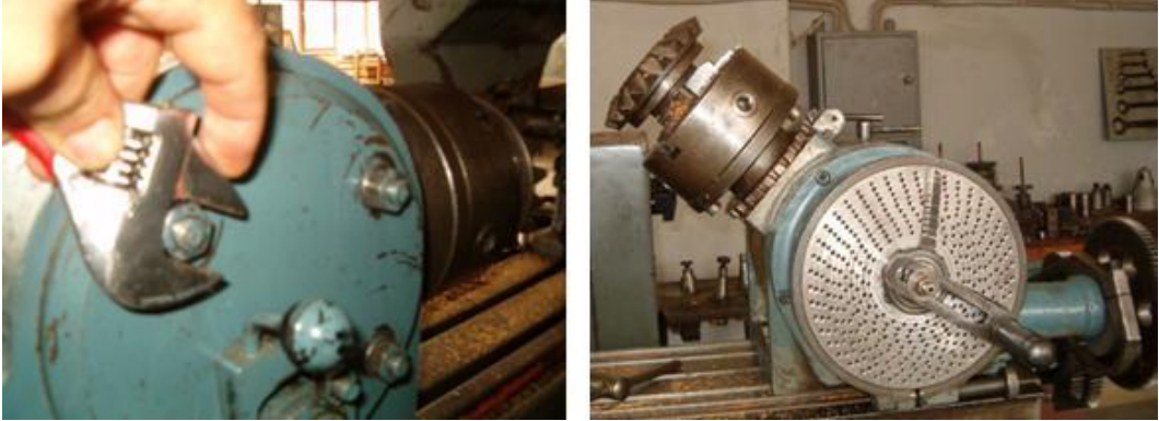
Resim 2.4: Açılacak konik dişli için aç verilmesi
