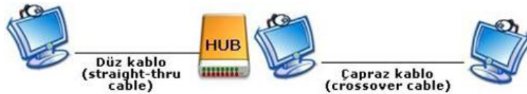
Resim 3.12: Düz ve çapraz kablo bağlantısı
