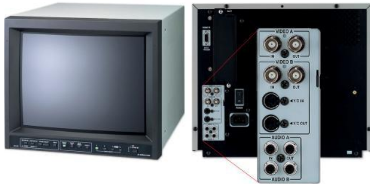
Resim 2.5: Güvenlik kamera bağlantı portları
