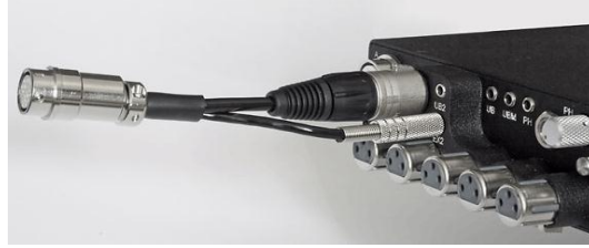
Resim 3.3: SCA Konektör ve bağlantı şekli
