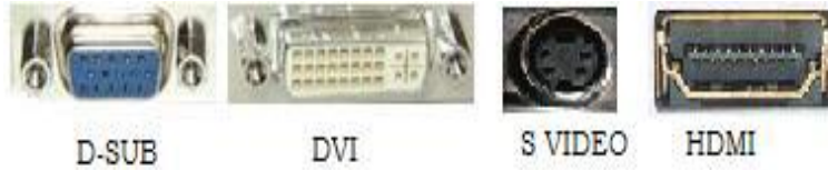
Resim 2.7: Ekran çıkış portu tipleri
