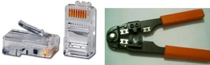
Şekil 3.4: RJ45 Konektörü ve sıkıştırma pensu
