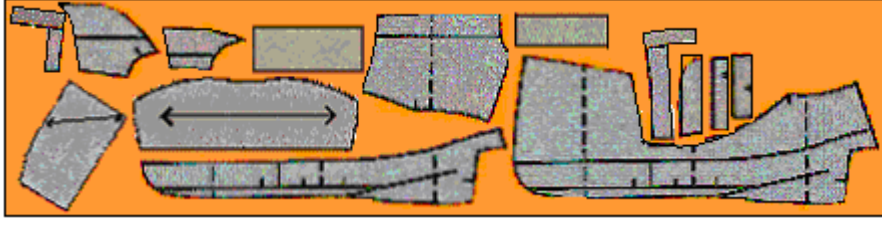
Şekil 3: Çift kat kumaşa tela kalıplarının yerleşimi
