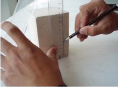
Resim 3.3: Kalemlik modelinin yandan görünüşünü markalama
