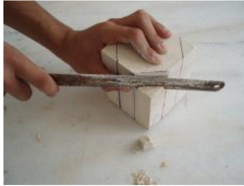
Resim 3.5:Kalemlik modeli için ana gövdeyi şekillendirme
