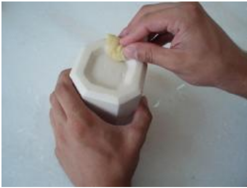
Resim 4.3:Kalemlik modelinin sünger rötüşunu yapma
