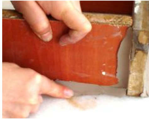
Resim 2.2: Kalemlik kütlesi oluşturmak için kalıp çerçevelerini hazırlama
