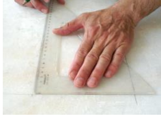
Resim2.1:Kalemlik ölçüsünü masa üzerine markalama
