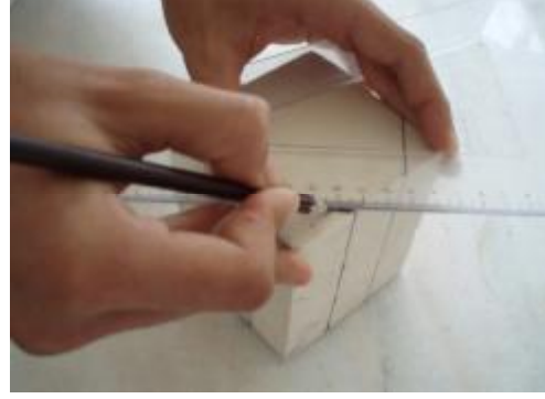
Resim 3.4 : Kalemlik modelinin üstten görünüşünü markalama
