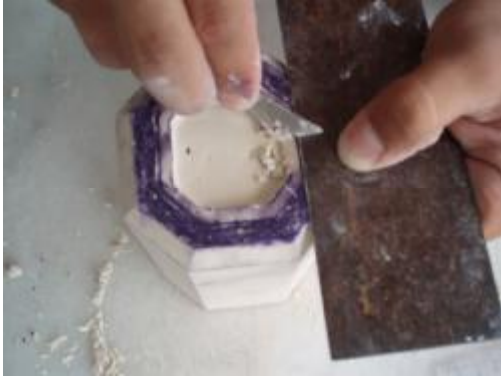
Resim 3.13: Ayağın iç yüzeyine eğim verme
