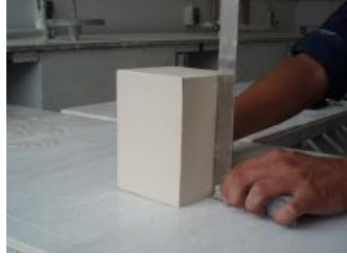
Resim 3.2: Alçı yüzeyini gönyesine getirme
