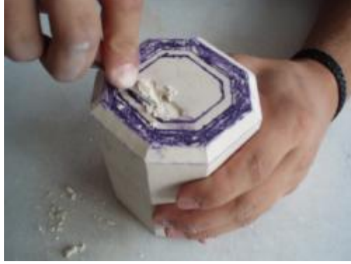
Resim 3.12: Ayağın iç yüzeyini oyma
