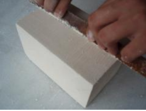
Resim 3.1: Alçı kütlesinin çapaklarını düzeltme
