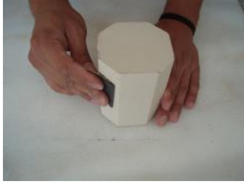
Resim 4.1 :Kalemlik modelinin kenar ve köşelerinin eğimini rötüşlama
