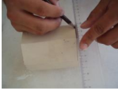
Resim 3.10: Ayak yüksekliğinin yan yüzeylere işaretlenmesi
