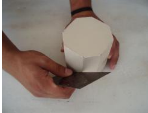
Resim 3.7: Kesilen kenar ve köşeleri düzeltme
