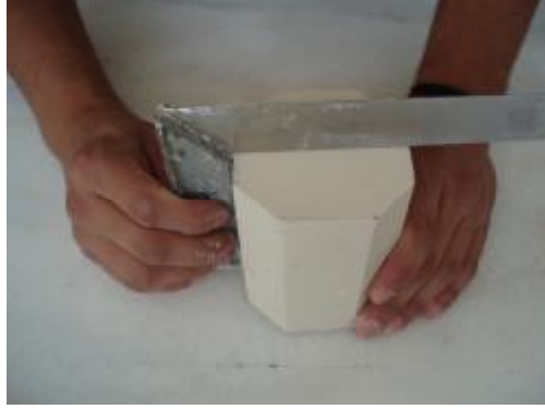
Resim 3.8:Yüzey düzlemlik kontrolü yapma
