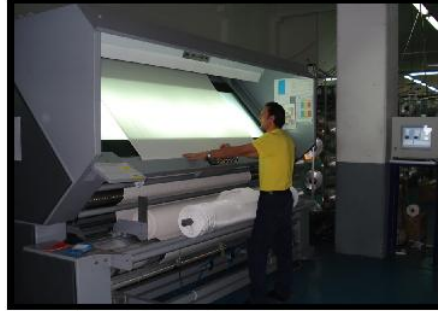
Resim 2.4: Ham örme kumaşın kontrol masasında eni ve boyunun kontrolü
