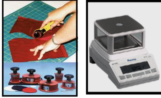
Resim 2.5: Kumaş gramajı ölçümü için kullanılan kesim aletleri ve hassas terazi
