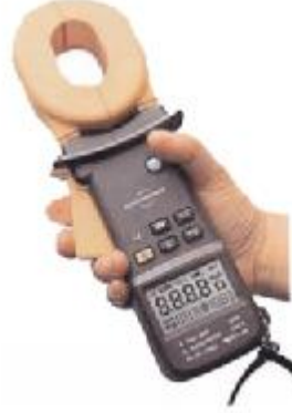
Resim 1.2: Pens tipi toprak ölçüm cihazı
