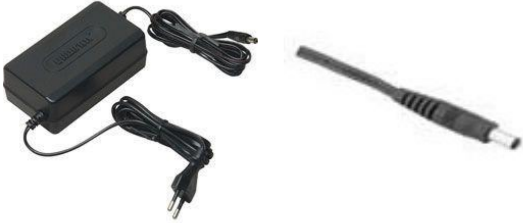
Resim3.5: Kamera adaptörü ve kamera enerji soketi
