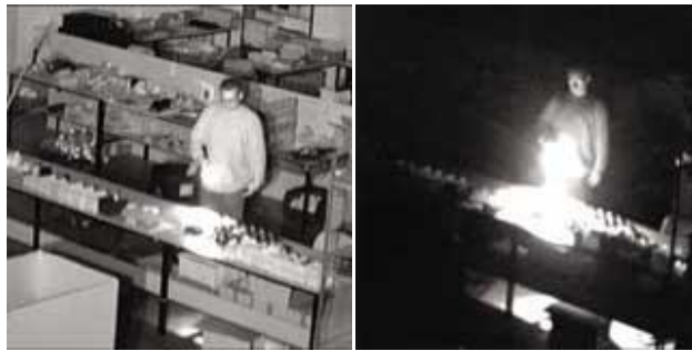
Resim3.6: IR ile aydınlatılmış ve aydınlatılmamış kamera görüntüsü
