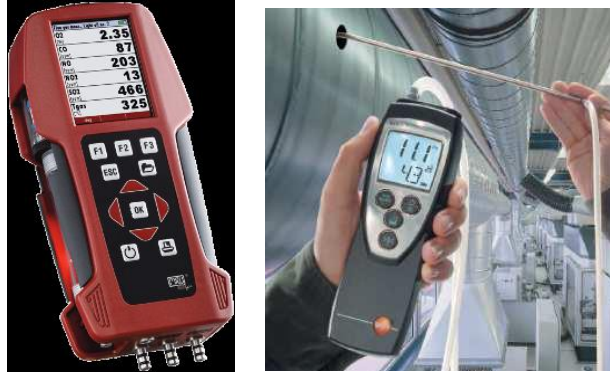
Resim 6.3: Baca gazı emisyon cihazı ile ölçme
