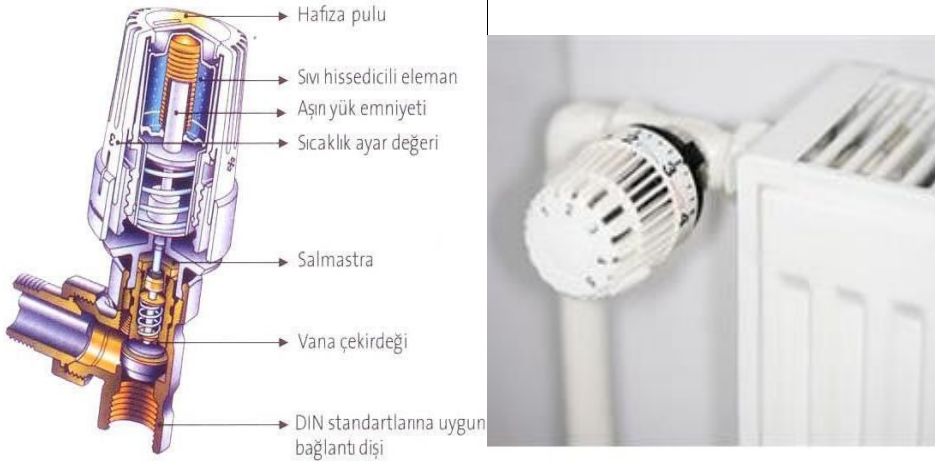
Şekil 5.4: Termostatik vananın iç yapısı ve radyatör üzerinde montaj hâli
