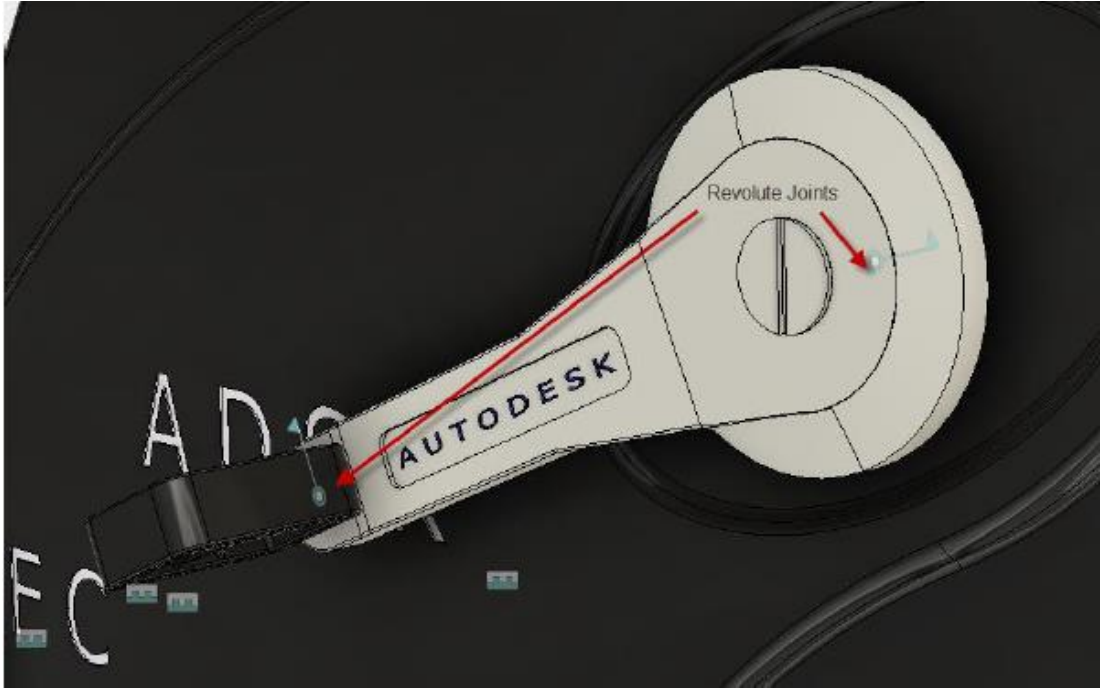
Fotoğraf 1. 9: Revolute/ Dönüş montaj ilişkisi
