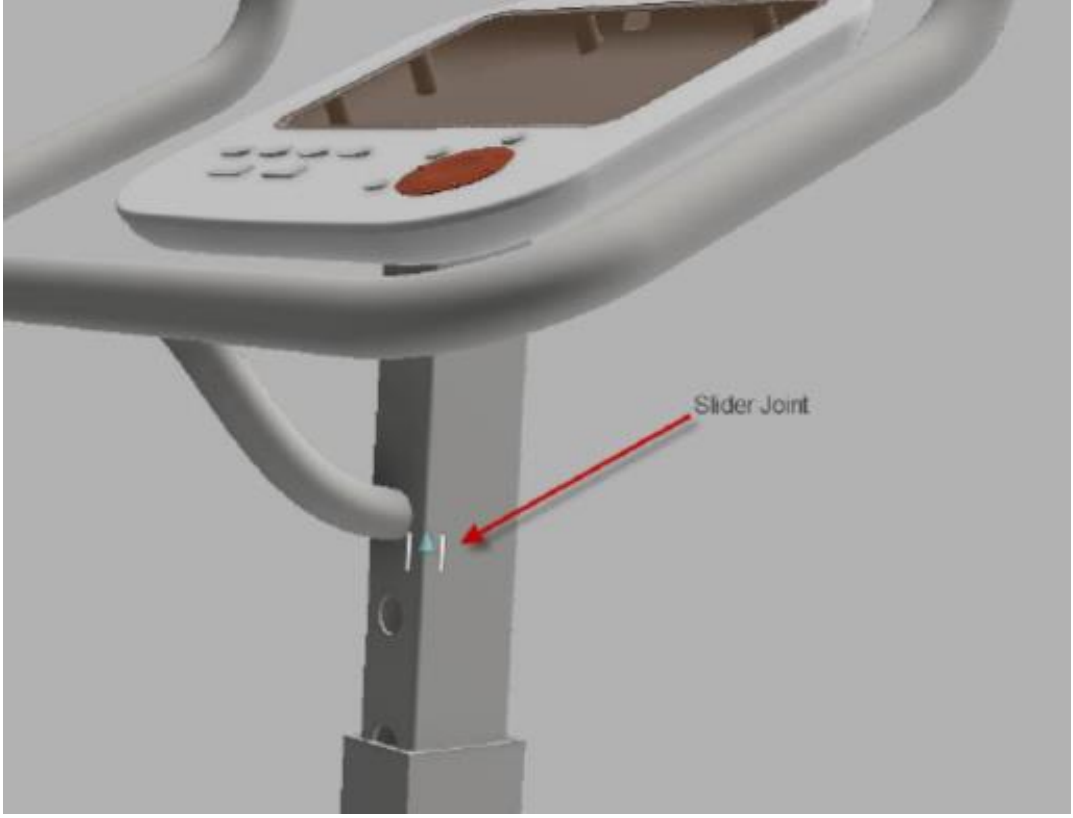
Fotoğraf 1. 101: Slider/ Sürgü-sürüş montaj ilişkisi
